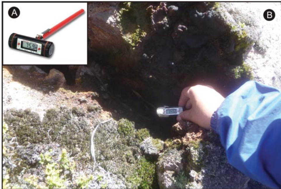
Figura 4.23 A) Termómetro utilizado para la medición de la temperatura; B) Proceso de medición de la temperatura en las grietas de la roca por donde emanaban los gases fumarólicos del volcán Huaynaputina.
