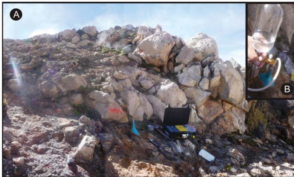
Figura 4.24 A) Ubicación de la estación de muestreo de gases HPT-F; B) Proceso de muestreo de gases en la estación HPT-F1.
