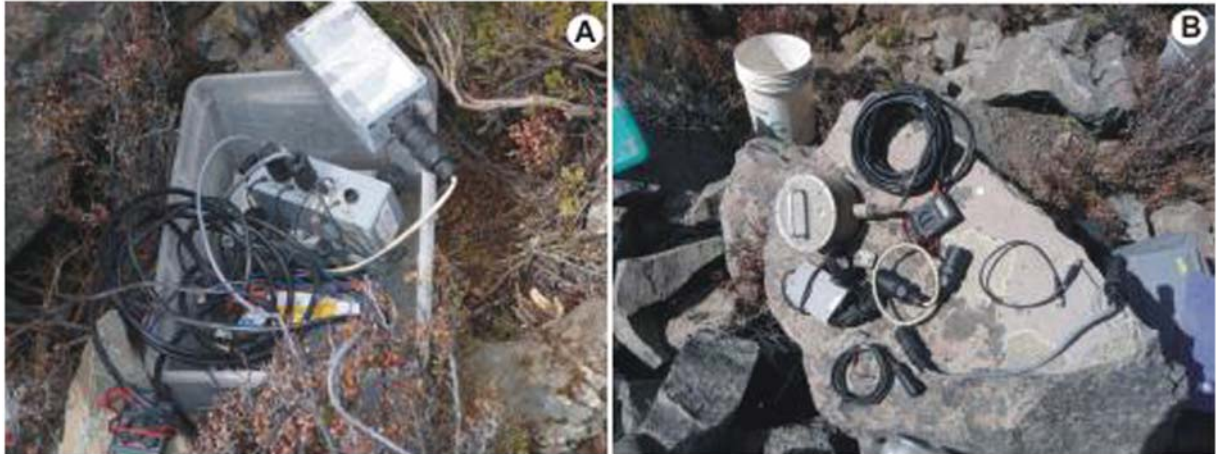
Figura 3.3 Estación sísmica TITAN. A) Registrador y discos de almacenamiento; B) Sensor sísmico y accesorios.
