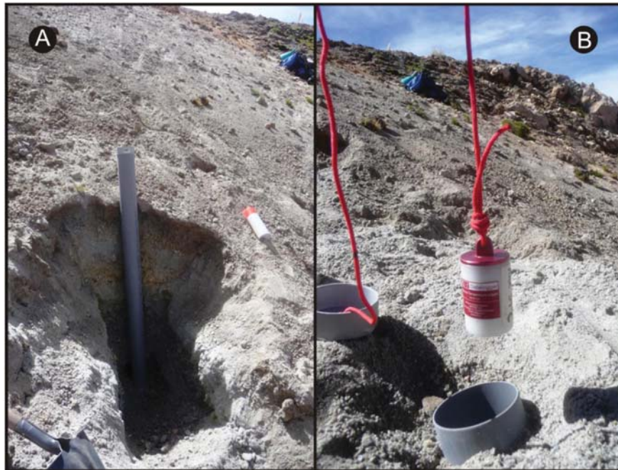
Figura 4.25 A) Instalación de la estación de medición continua de la temperatura HPT-F1 en el volcán Huaynaputina; B) Foto del momento en que se introduce el registrador HOBO UTL-1 en la estación HPT-F1.
