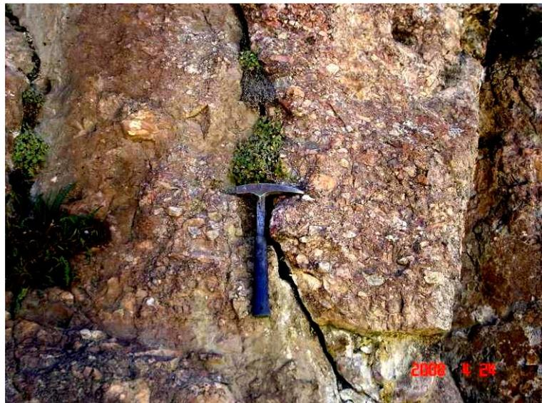
Foto N° 10: Detalle de los conglomerados del Grupo Mitu. Margen derecha del Río Ramis. En el lugar donde se construirá la Presa B3
