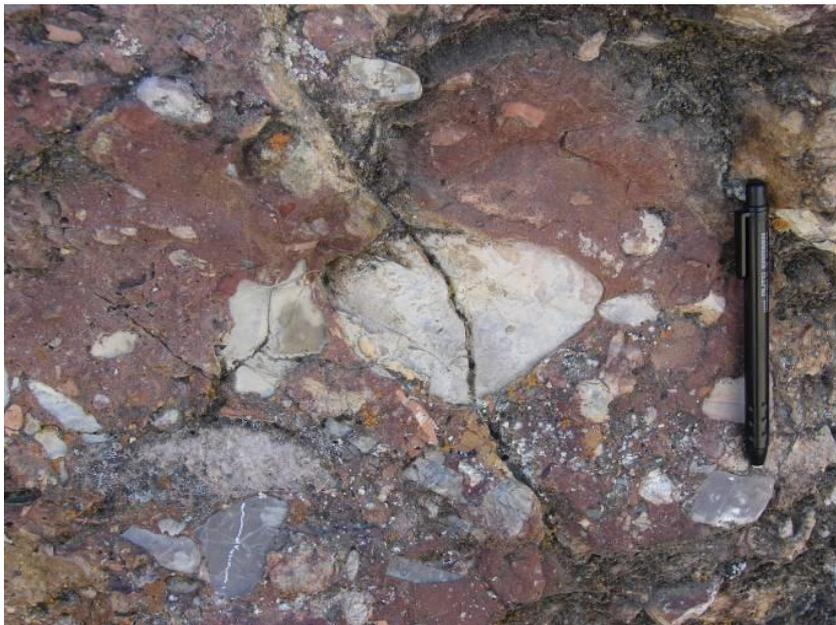
**Foto N° 33: Presa B3, estribos izquierdo y derecho. Detalle del material donde se asentaran los estribos, conglomerados soldados de resistencia media a dura.**
