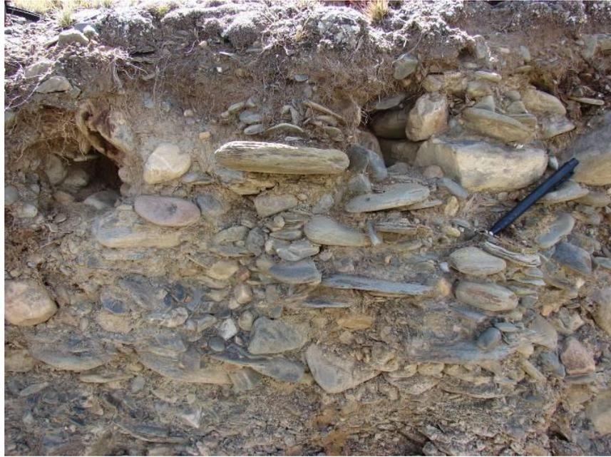
Foto N° 18: Detalle del material en el cual se asentará el estribo izquierdo de la Presa B1. Gravas GW-GM
