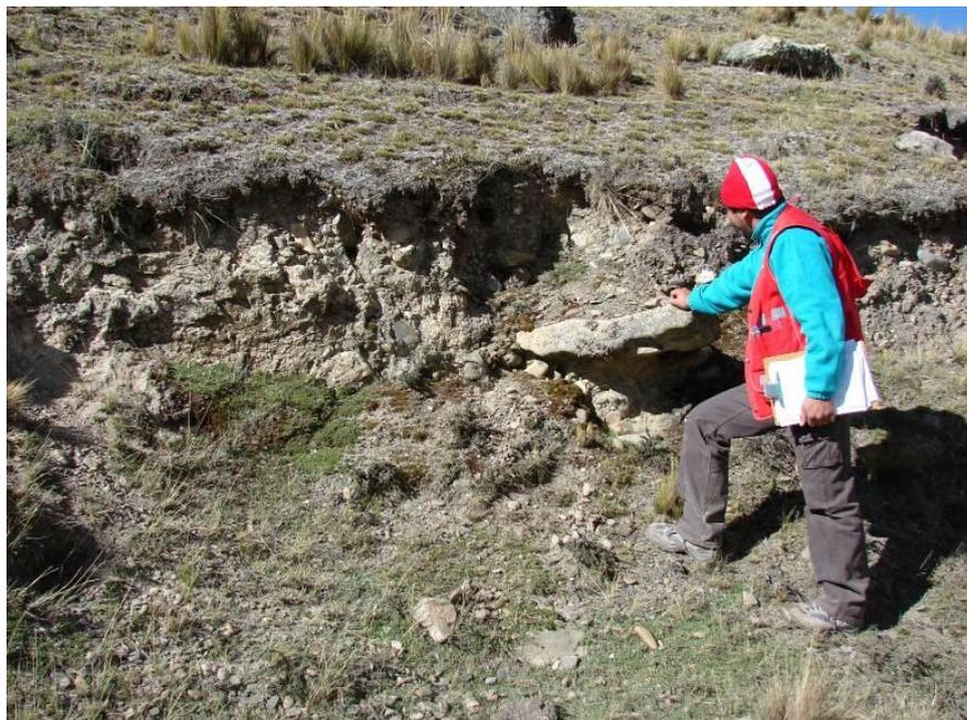
Foto N° 27: Detalle de los materiales donde se sentará el estribo derecho de la Presa B2
