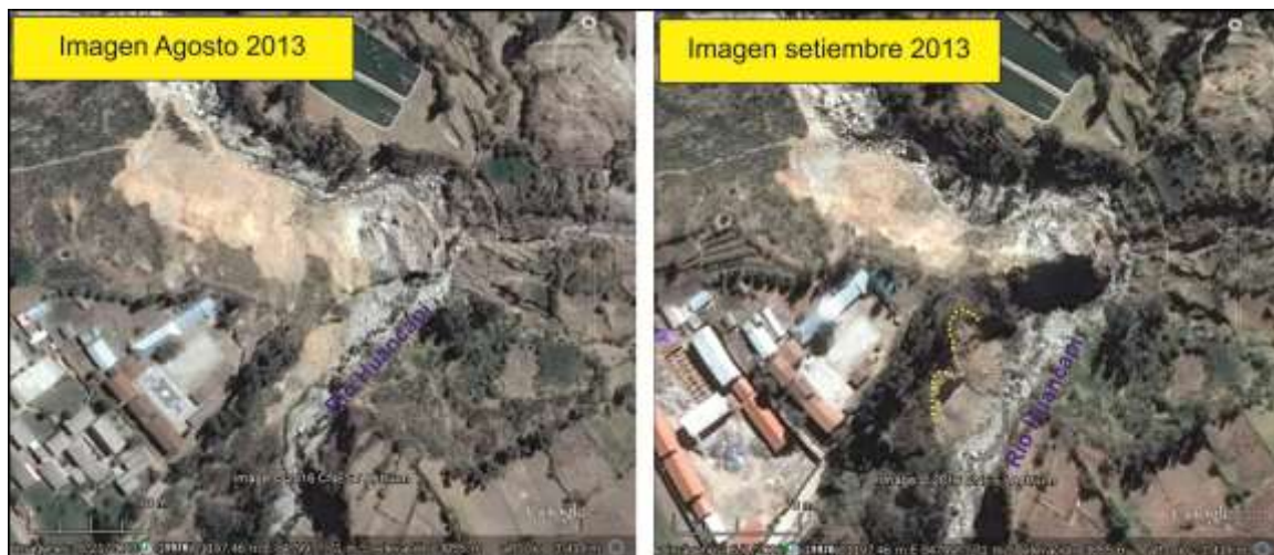
Figuras 12 y 13. Imágenes satelitales del sector de Colegio Agropecuario, en la imagen de agosto 2013, no se aprecia el deslizamiento, en cambio en la de setiembre 2013, se aprecia el deslizamiento (líneas amarillas) y la variación del cauce del río Huancapi.
