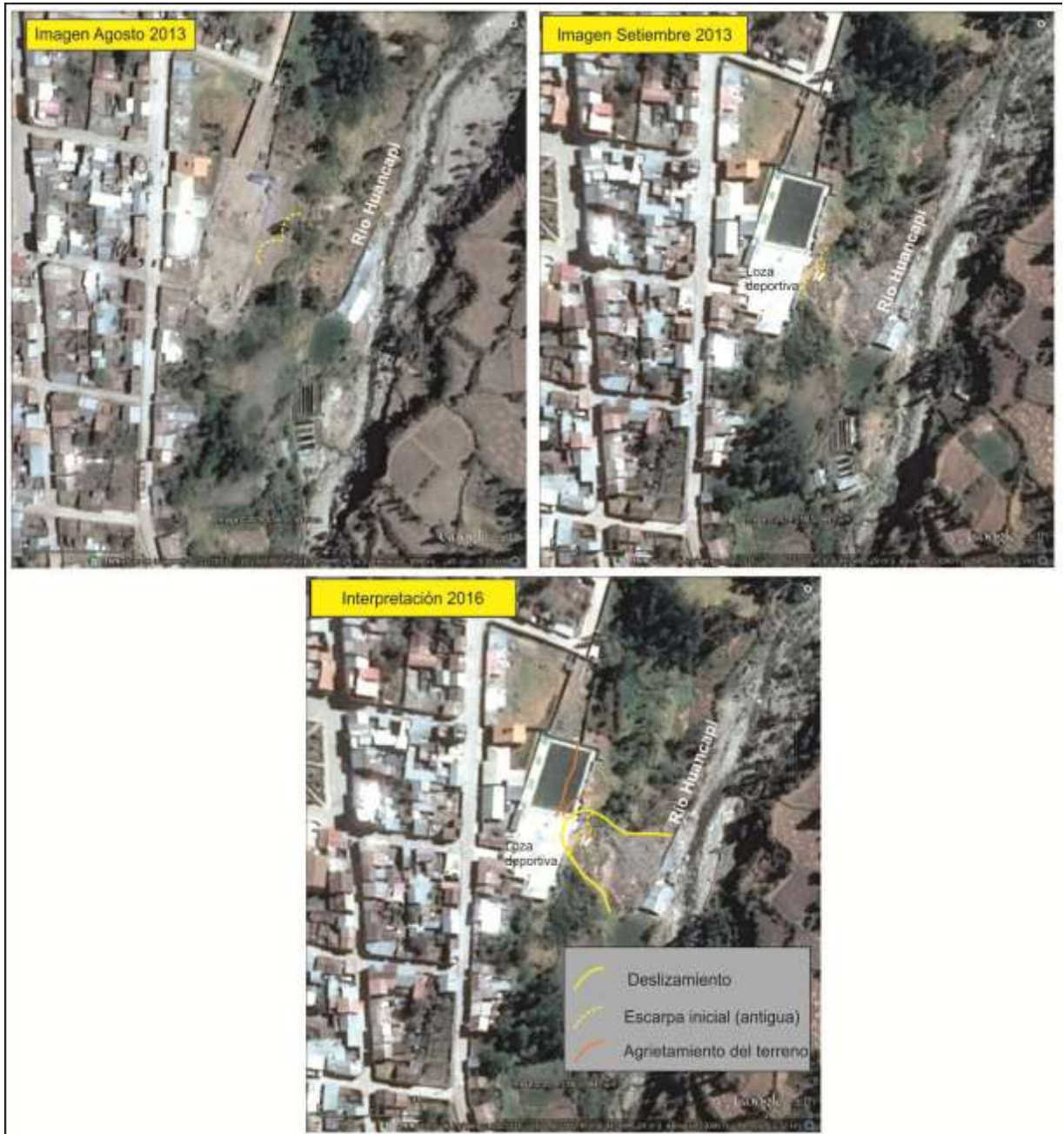
Figura 11. Análisis temporal de imágenes satelitales donde se muestra la evolución de la zona afectada por deslizamiento.
