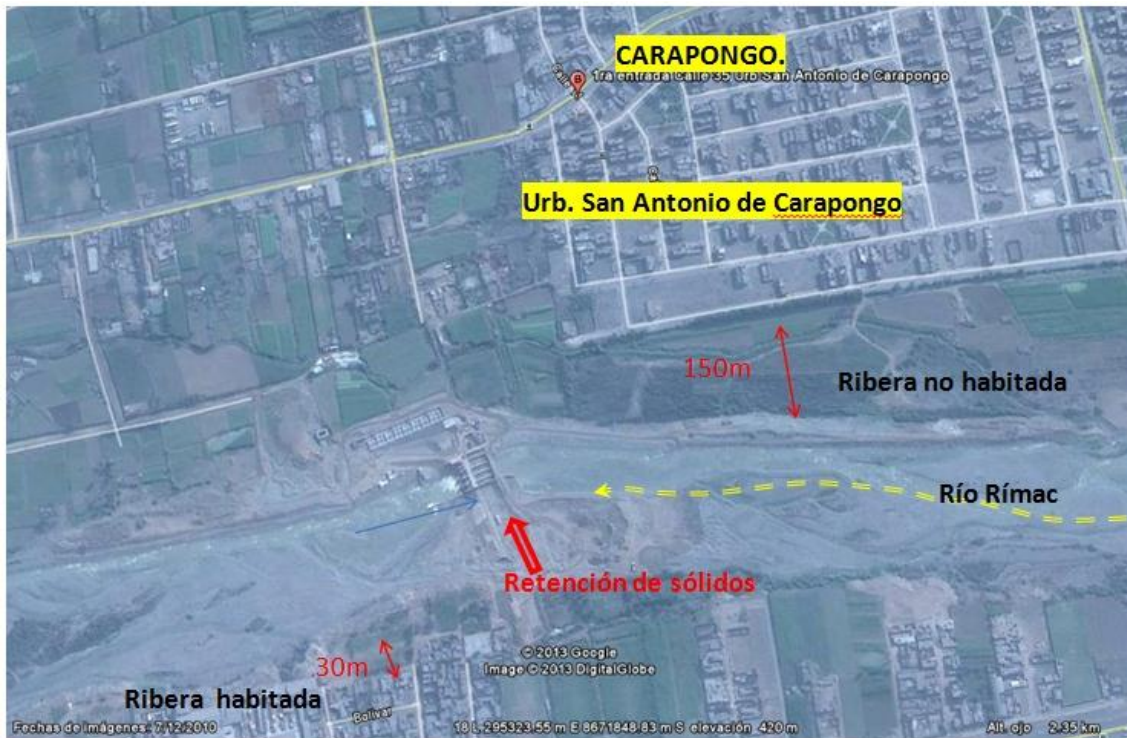
Figura 27: Obsérvese que la Urb. San Antonio de Carapongo se asienta a 150 m del lecho del río. Por otro lado, aguas abajo se observa que las viviendas han sido construidas a escasos 30 m del lecho, siendo estas últimas más susceptibles a peligros de inundación que las viviendas asentadas en la urbanización antes indicada.
