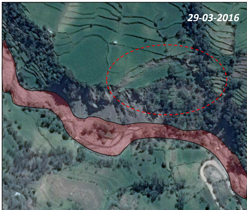
Foto 17: Río Llato, en el sector Chupacra, activación de un deslizamiento por efecto de socavación fluvial después del aluvión del 2016.
