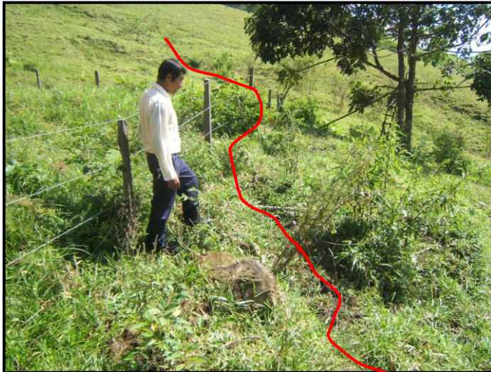
Foto 5 y 6.- Se observan los agrietamientos en el cuerpo del deslizamiento.
