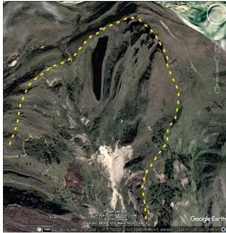
Figura 8. Forma de la escarpa del deslizamiento antiguo (línea amarilla).
