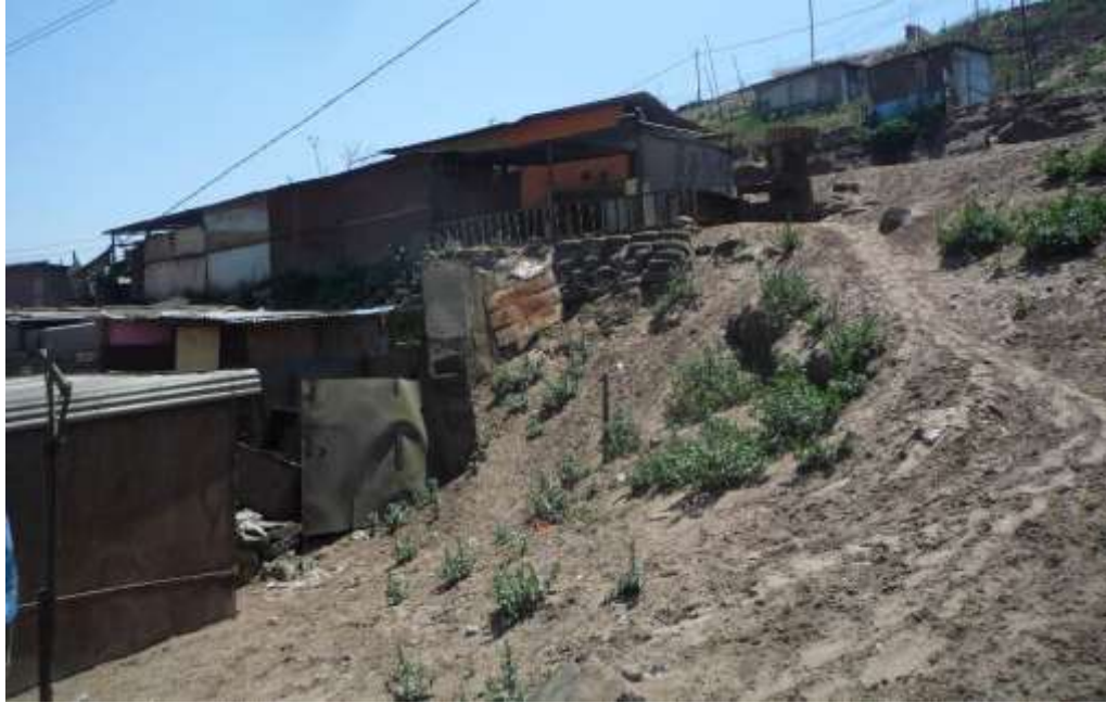
Foto 10. AH. 08 de Enero. Obsérvese que la ladera está cubierta de depósitos eólicos.
