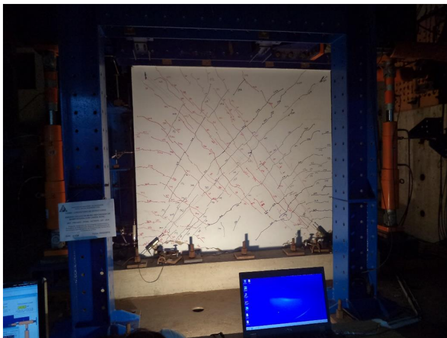
Figura 39. Estado final (distorsión = 1/154) MTUB-R
