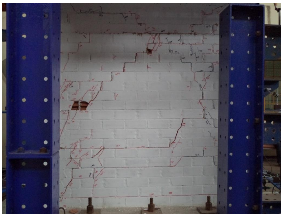
Figura 22. Grietas de espesor máximo de 8 mm
