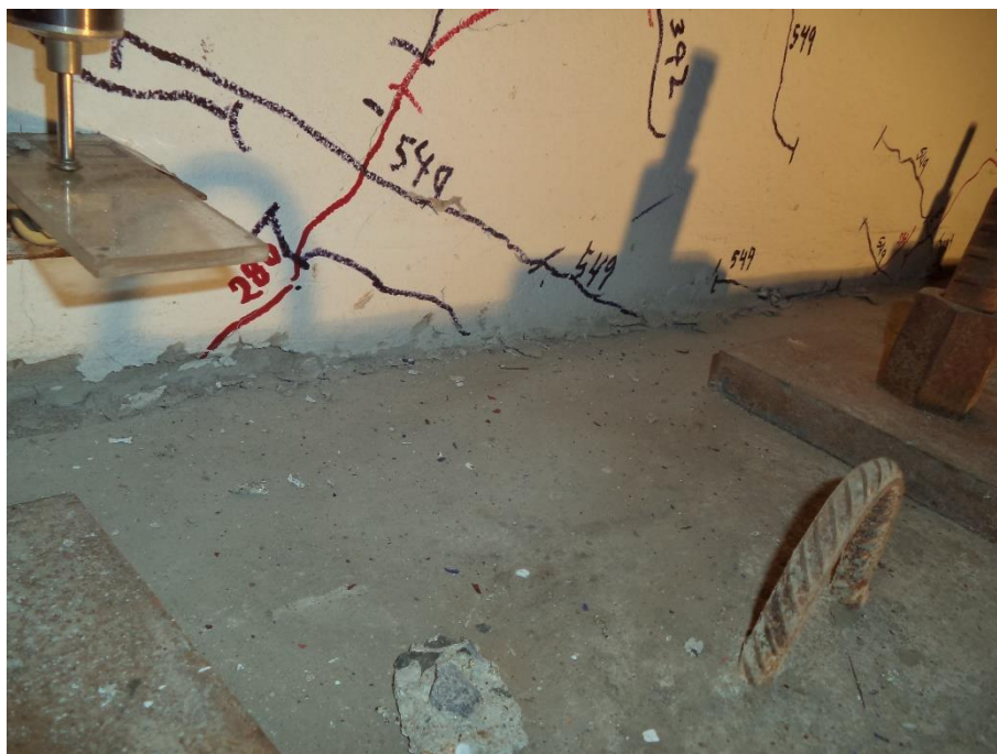
Figura 38. Figuración en base (distorsión = 1/200) MTUB-R
