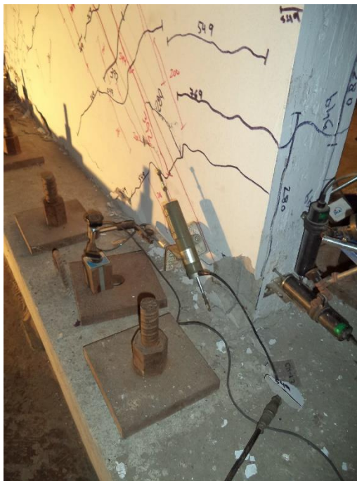
Figura 40. Estado final daño del talón (distorsión = 1/154) MTUB-R
