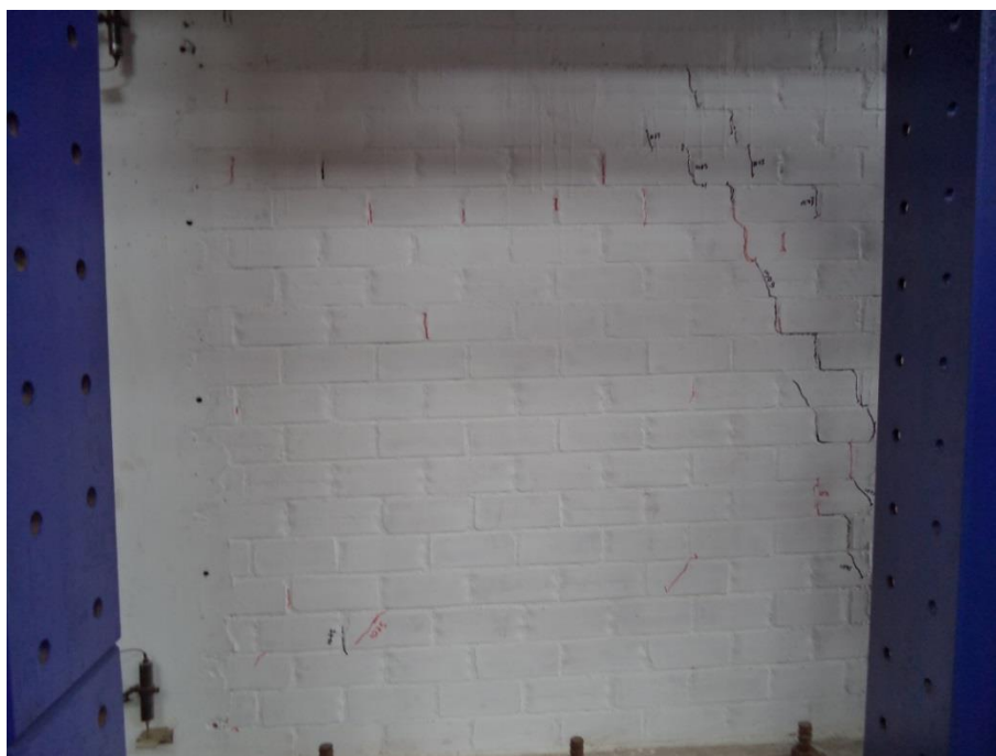
Figura 18. Inicio de las primera grietas en las juntas de albañilería, distorsión 1/1503
