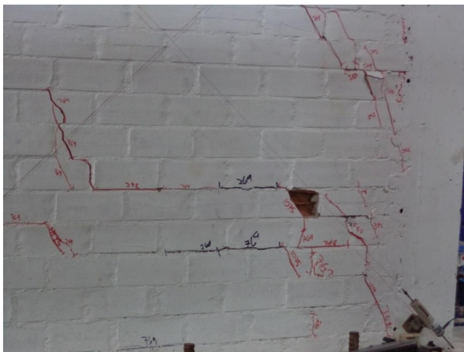
Figura 20. Desprendimiento de parte del ladrillo pandereta, falla frágil del ladrillo
