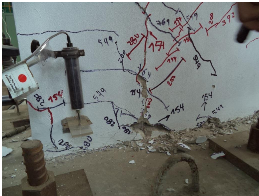
Figura 29. Aplastamiento en el talón del muro
