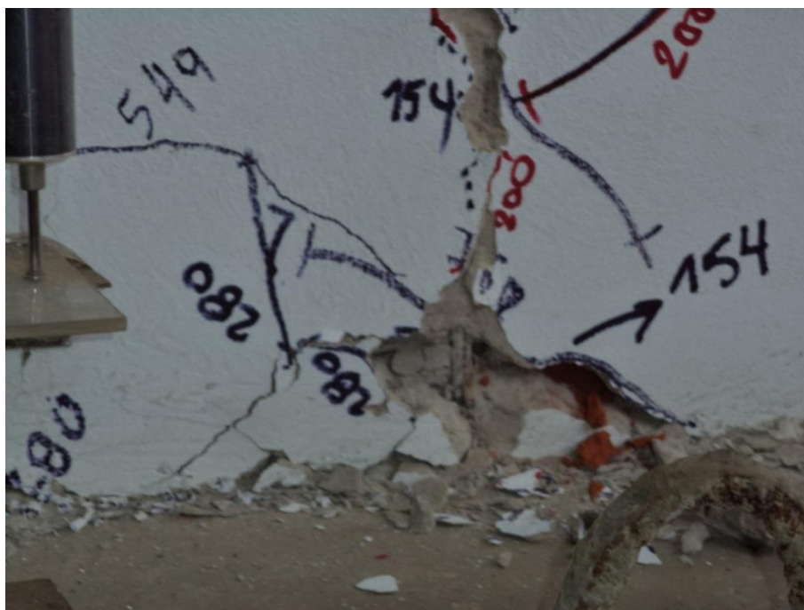
Figura 30. Desprendimiento del talón del muro
