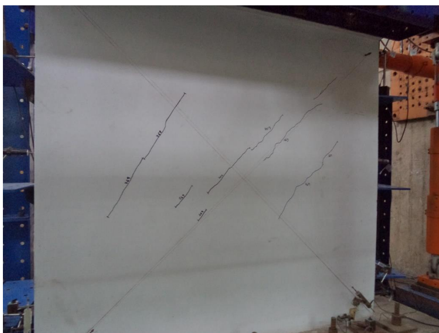
Figura 33. Inicio del agrietamiento diagonal (distorsión = 1/759) MTUB-R
