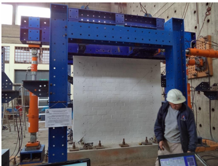
Figura 17. Inicio del ensayo, distorsión de 1/4167
