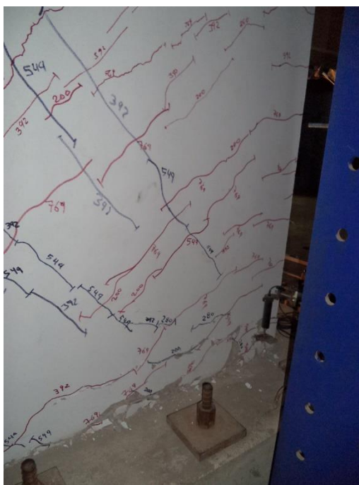
Figura 41. Estado final daño del talón (distorsión = 1/154) MTUB-R
