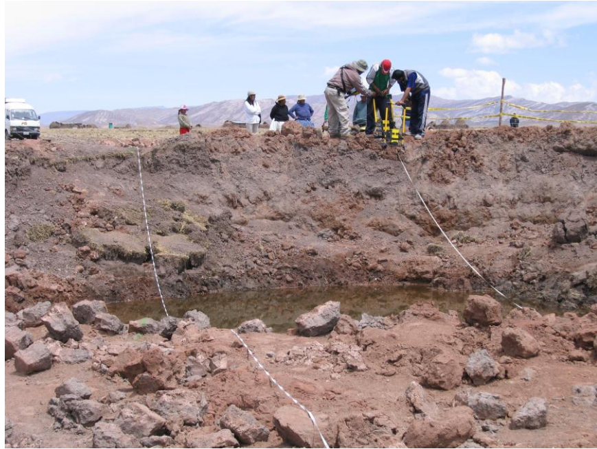
Foto N° 1: Vista panorámica hacia noreste del área de investigación geofísica donde se muestra los sectores y líneas ejecutadas con Georadar GPR-Pulse Ekko Pro.
