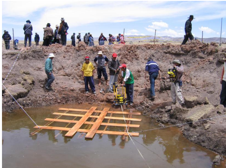
Foto N° 2: Vista del armado del Equipo de Georadar nótese las dos antenas Receptor y trasmisor el pulsador y DVL del Georadar GPR-Pulse Ekko Pro.
