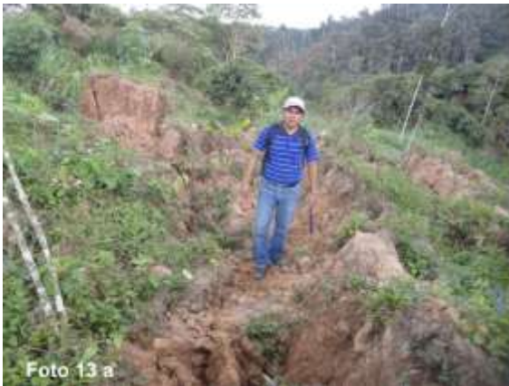
Fotos 13a y 13b. Asentamientos del terreno en el cuerpo del deslizamiento de El mirador.
