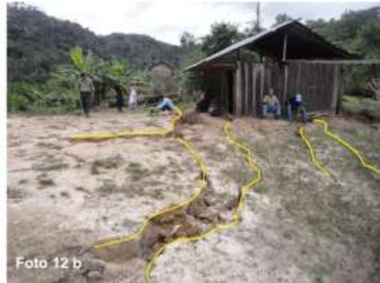
Fotos 12a y 12b. Agrietamientos en el cuerpo del deslizamiento que afectaron viviendas del caserío El Mirador.
