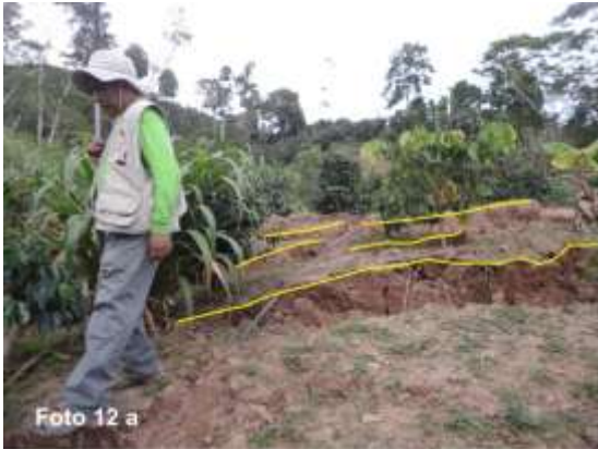
Fotos 12a y 12b. Agrietamientos en el cuerpo del deslizamiento que afectaron viviendas del caserío El Mirador.
