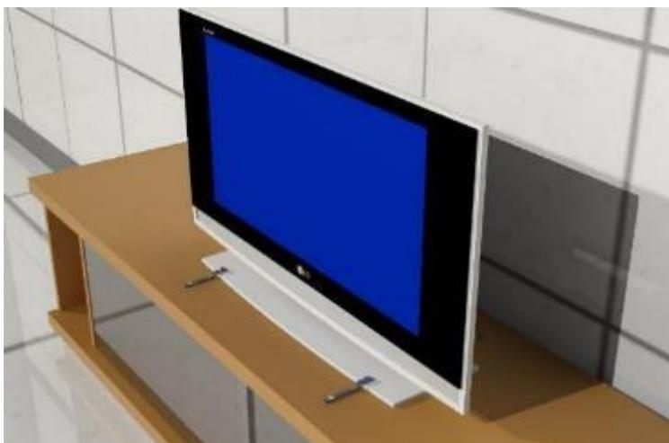
**Figura 51.** Formas de asegurar equipos electrónicos, mediante seguros de correas
