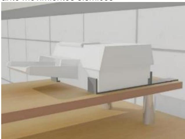
**Figura 47.** Equipos como impresoras deben estar sujetos a asegurados para evitar su desplazamiento ante movimientos sísmicos.
