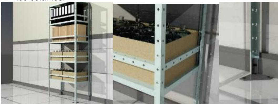
**Figura 56.** Sistema de aseguramiento de las unidades almacenadas en las estanterías, se evita caída de estanterías y desplazamiento y caída del contenido
