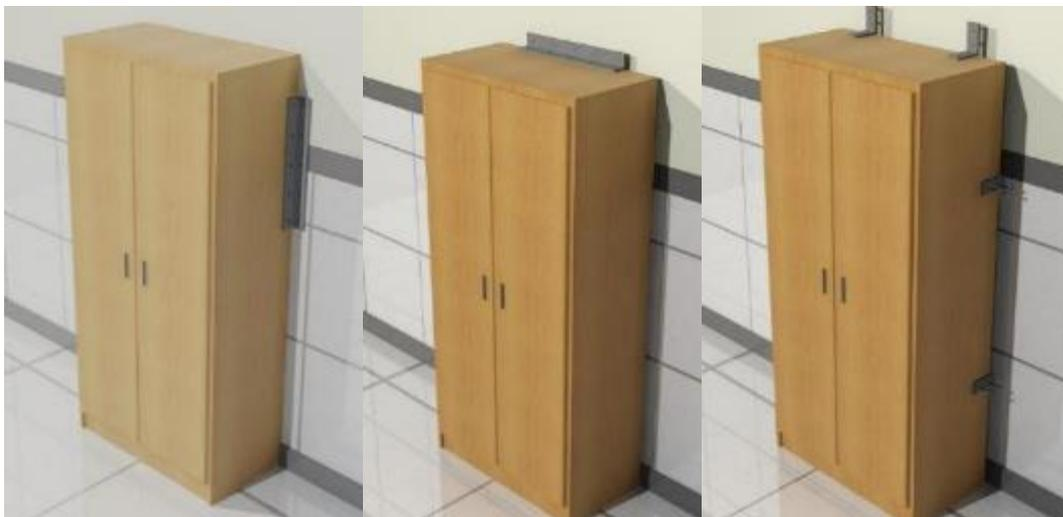
**Figura 49.** Muebles y armarios deben estar fijados y asegurados afín de evitar caídas que afecten al personal de salud o que obstruyan salidas o corredores de evacuación.
