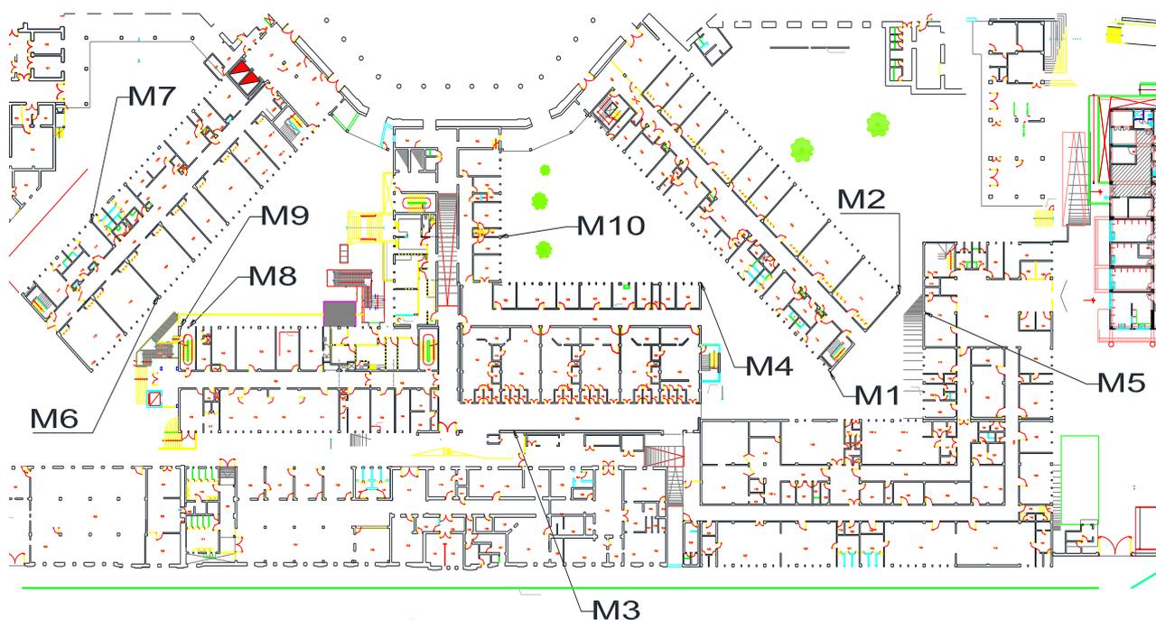
**Figura 8.** Ubicación de puntos de extracción de núcleos de concreto.
