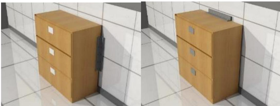
**Figura 48.** Archivadores deben estar asegurados y evitar caídas que obstruyan salidas o corredores de evacuación.
