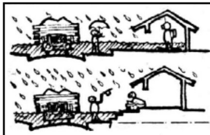
El Estudio Topográfico determinará las pendientes y direcciones de las aguas de escorrentía superficial
