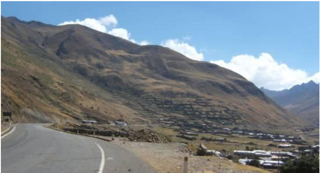
Foto 54 Sector de Pariacancha (Pachapaqui), vista hacia el noreste que muestra una superficie cóncava de escarpa antigua de deslizamiento y un depósito al pie, a manera de flujo.
