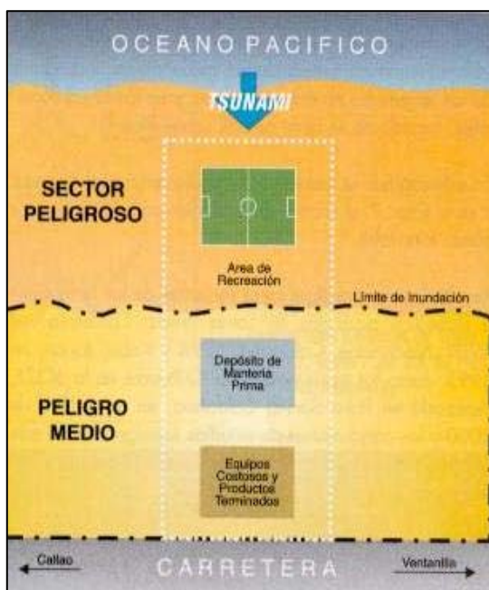
Fig. 1.8 Planta industrial al N-W de Lima y Plot-plan de acuerdo a la importancia de edificios y contenidos
