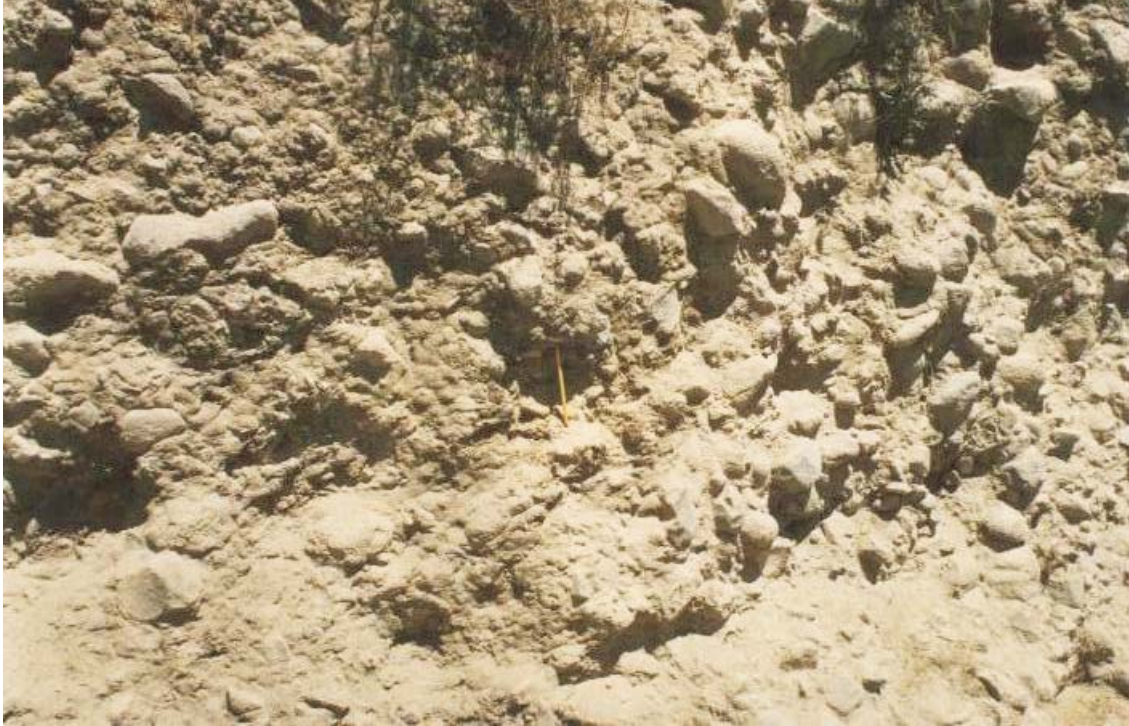
Foto 5: Corte donde se observa el tipo de material del poblado de Huanca, consistente en conglomerado medianamente denso
