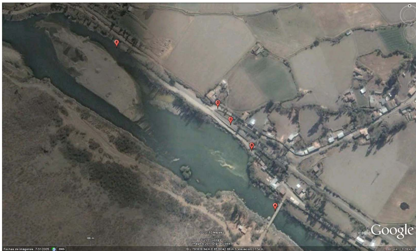
Fig. 03: Sector de Tanccac Pampa. El Punto A corresponde al colapsado Puesto San Pedro. Punto B: Erosión de las riveras por crecida del río. Punto C: Ubicación actual de la carretera Ollantaytambo – Piscaycucho. Punto D: Ubicación actual de la línea férrea Ollantaytambo - Aguas Calientes. Punto E: Ubicación actual de la ribera del río.
