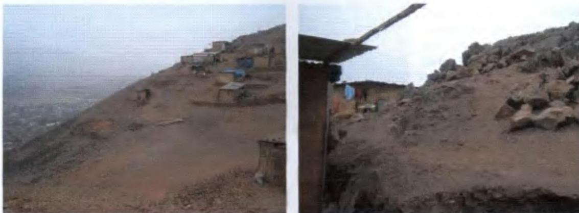
Fotos N° 9 y 10. Se observan rocas sueltas angulosas en la ladera de fuerte pendiente, las cuales podrían caer y afectar a las manzanas "D", "E" y "F".
