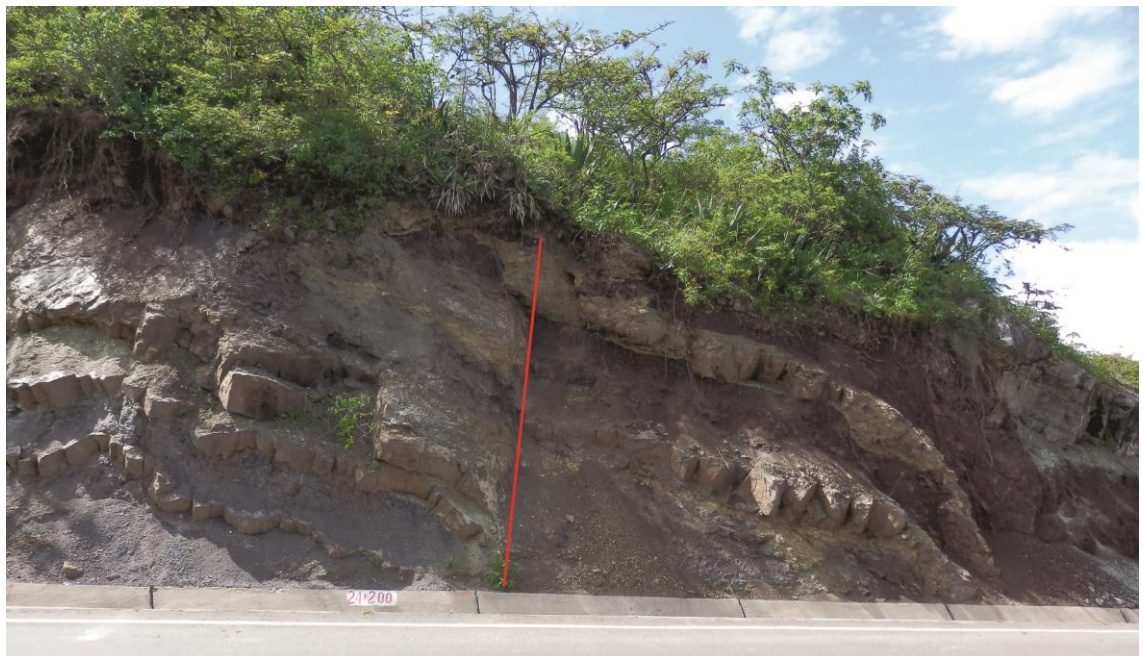
Foto 2. Se observa evidencia de deformación a un sistema de falla inversa con dirección NW-SE, (la línea roja es referencial) se puede notar claramente el cambio en los flujos piroclásticos brechados y cenizas de tono rojizo.
