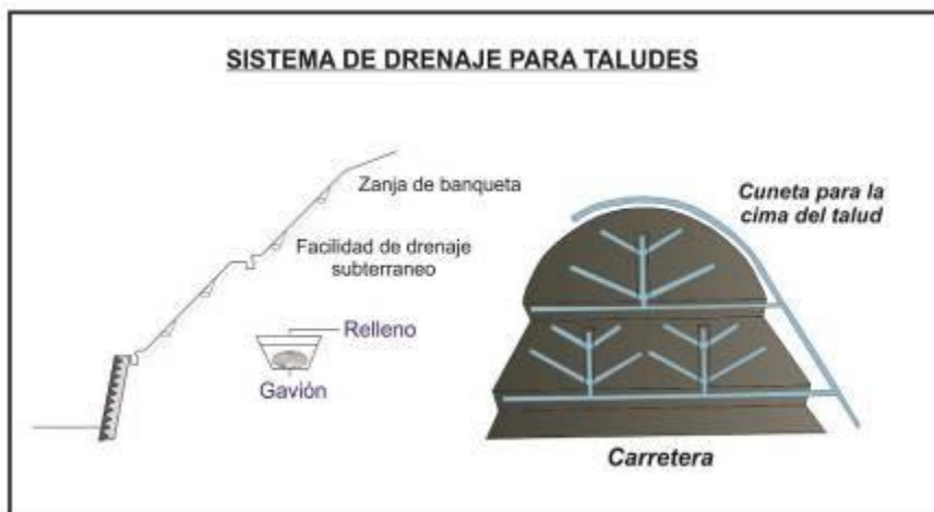
Figura 8. Sistema de drenaje tipo espina de pez.
