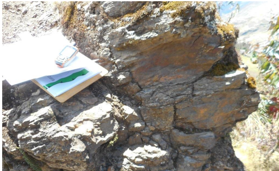
Foto 17: Estratos de arenisca intensamente diaclasada en la parte alta del cerro Cebollita pertenecientes a la Fm. Chicama, en algunos casos los clastos y bloques se desprenden pendiente abajo.
