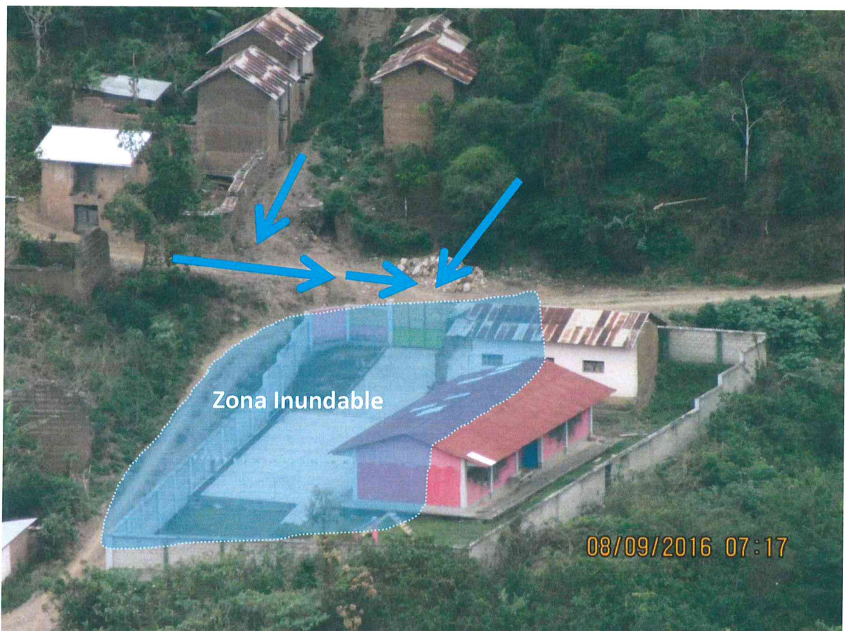
Foto 26. Confluencia de flujos de agua que inunda a la I.E. 342 (Barrio Tambopata).
