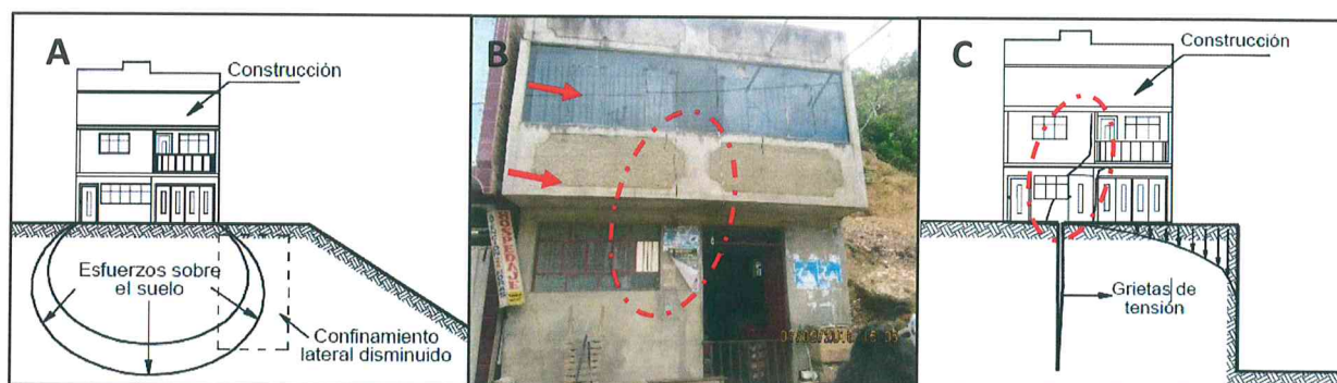
Fig. 14. Efectos de las edificaciones sobre el talud de un deslizamiento. A. Esquema de taludes con falta de confinamiento lateral. B. Vivienda con fisuramientos e inclinación de muros. C. Ocurrencia de agrietamientos relacionados a esfuerzos de tensión.
