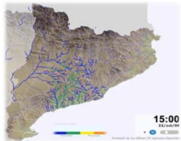
Figura 4. Muestra de alertas de lluvia acumulada por subcuencas (arriba) y lluvia drenante hacia los cauces fluviales (abajo) con una antelación de 2 horas.
