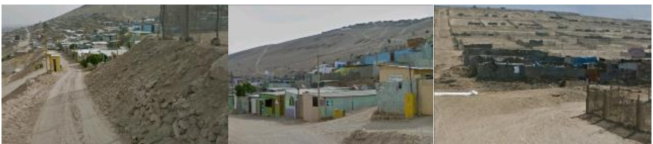
Foto 8. Viviendas ubicadas en la ladera del cerro Intiorko (tomada de Google Earth). En caso de sismos las pircas y los bloques suspendidos en las laderas del cerro Intiorko pueden ceder y afectar a las viviendas que se encuentran en la parte inferior. Si a esto le sumamos la mala calidad de suelo, pueden colapsar algunas viviendas.
