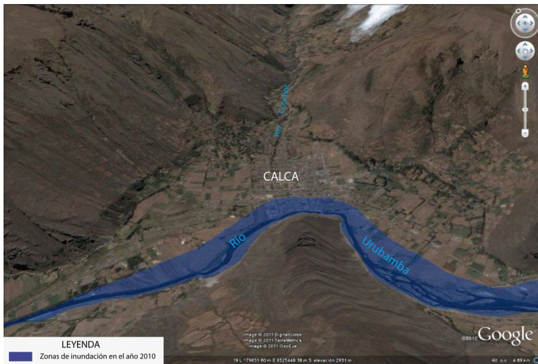
Figura 13: Vista aérea de la ciudad de Calca emplazada sobre el abanico aluvial. El polígono azul representa las zonas inundadas con las lluvias de febrero del 2011. Google Earth
