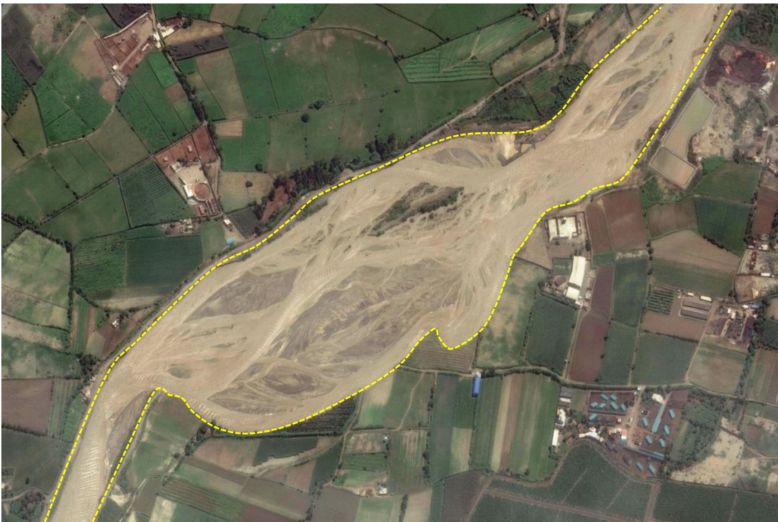
Figura 5. Se observa el cauce afectado por la erosión fluvial. Imagen satelital, marzo 2017 (Fuente: Google Earth Pro).
