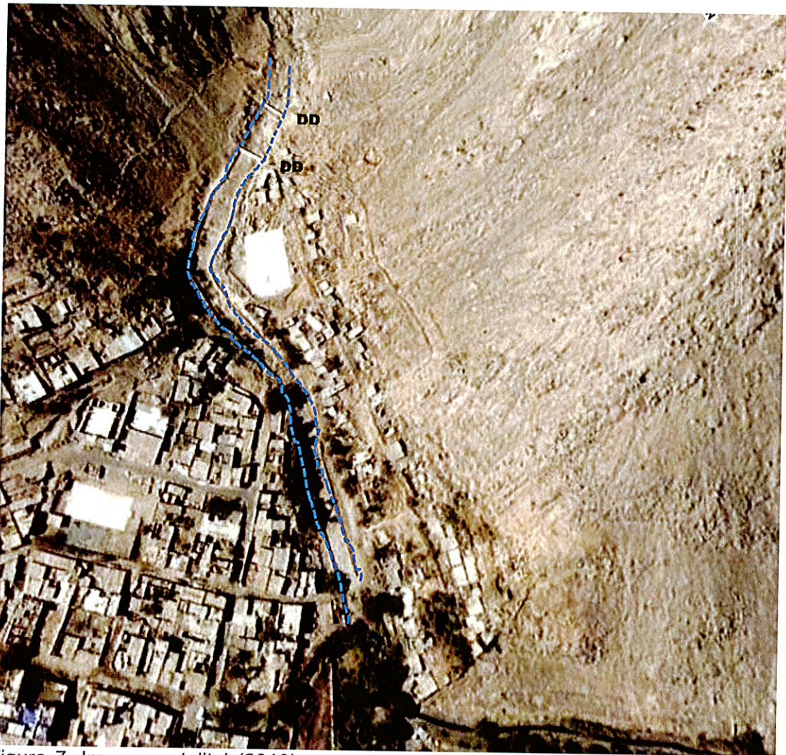
Figura 7. Imagen satelital (2010) que muestra la canalización de la quebrada Santo Domingo; se distingue dos diques disipadores.
