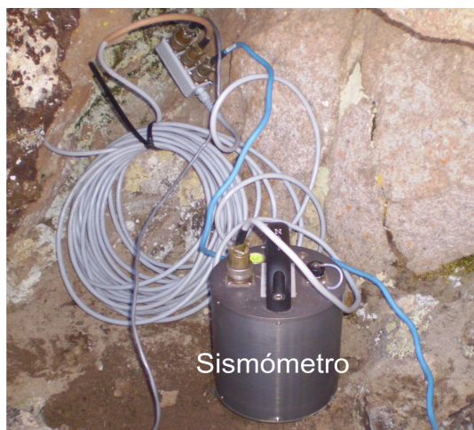
Foto II-6. Sismómetro utilizado en el volcán Ubinas (Monitoreo sísmico de INGEMMET).
