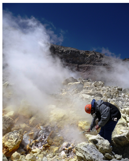
Foto II-9. Toma de muestras de gases y temperaturas, volcán Misti (P. Masías, INGEMMET).
