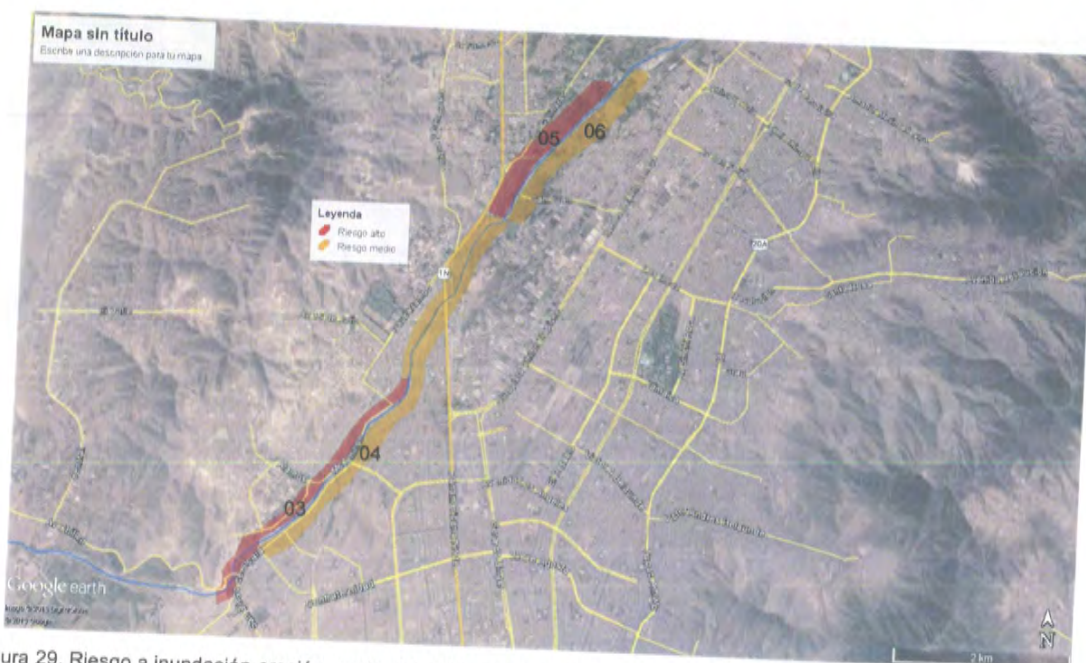
Figura 29. Riesgo a inundación-erosión, sector 03 al 06, en los distritos de Puente Piedra, Comas y Los Olivos
