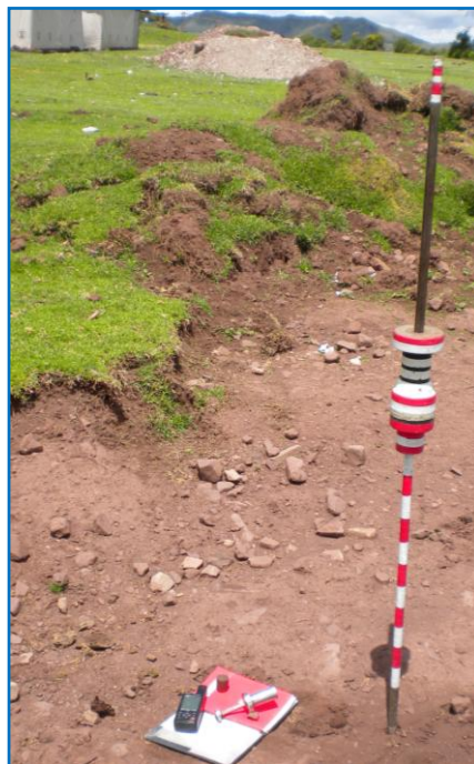
Vista auscultación dinámica con PDL ZURITE Sector Erapata.
