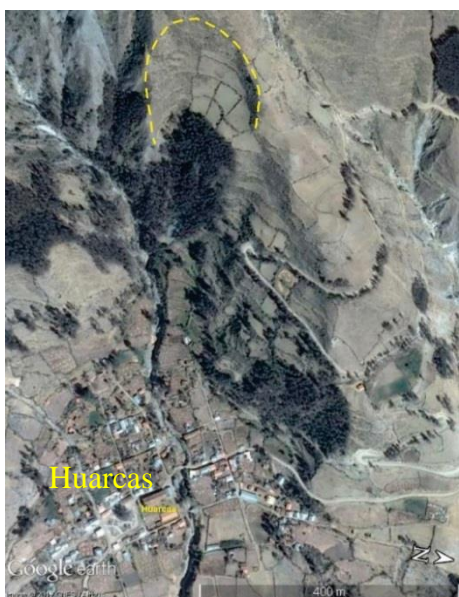
Foto 5. Escarpa y depósito adyacente en forma de lomerío originado por la masa deslizada basculada de manera rotacional.
