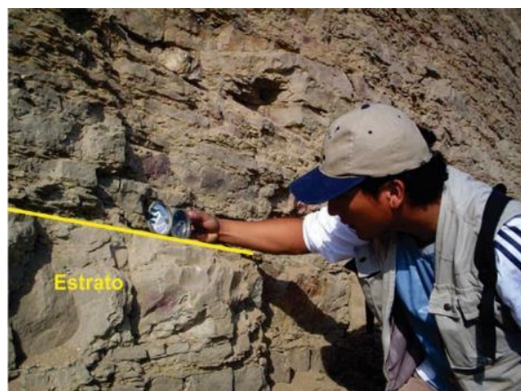
g) Fotos 12 y 13. Buzamiento de los estratos (líneas amarillas indican la inclinación).
