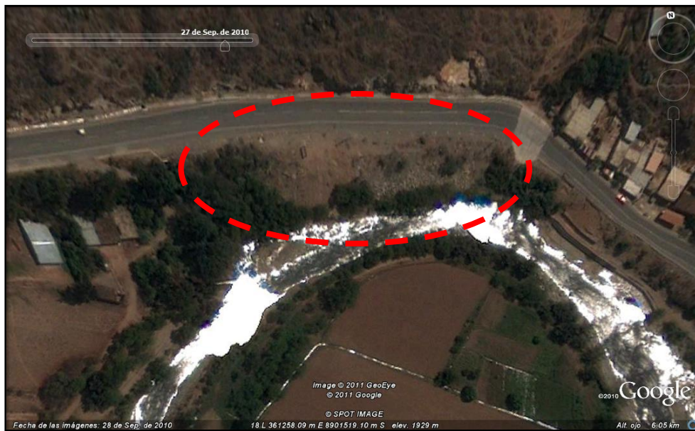
Figura 7.- Imagen Satelital del 2010, donde se muestra el estrechamiento del cauce del río.
