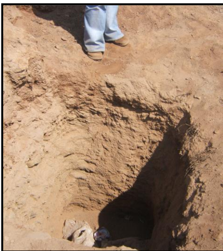
Foto 6.- Calicata de 1,40 m. muestra un suelo arenoso con algo de grava y bloques, es medianamente compacto.
