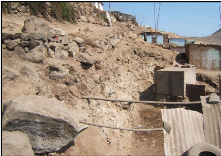
Foto 5.- Espesor del suelo en la manzana "K", constituido por bolones, gravas en una matriz areno-limosa.
