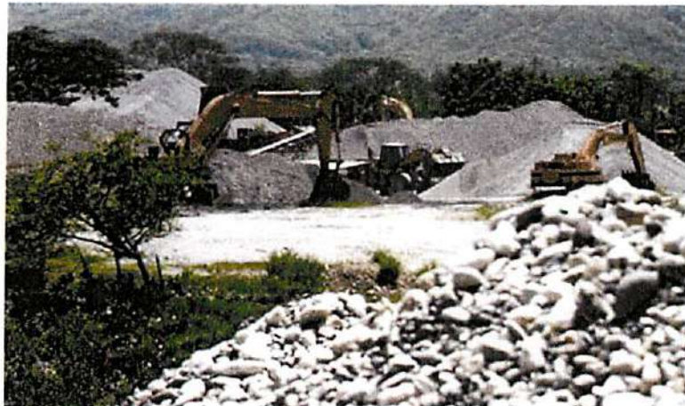
Imagen N° 02: Extracción de material de acarreo descontrolado en el río Vilcanota
