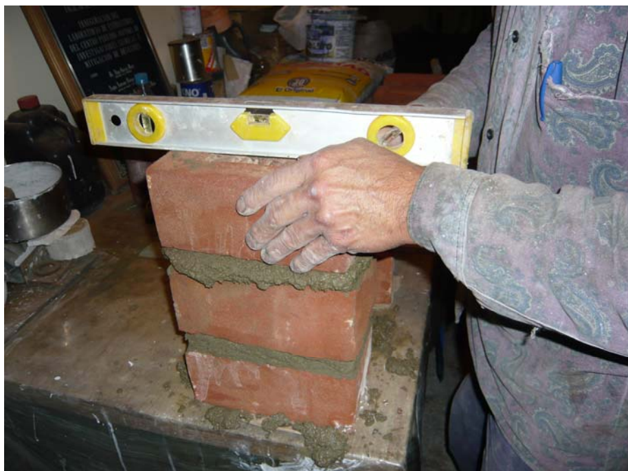
Foto 5.6. Pila de ladrillo "Inca".
