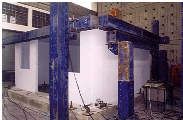
Foto 5.3. Módulo ensayado del Sistema C.
