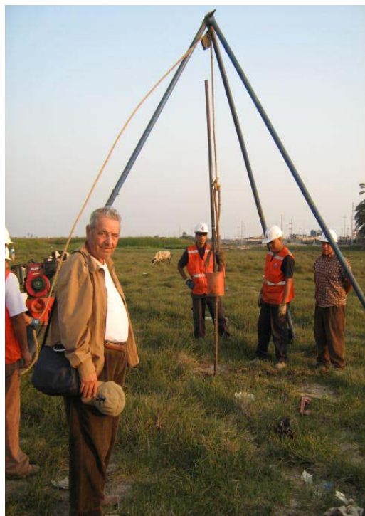
Foto 3.8. Prueba de Cono Peck cerca al pozo de agua en reparación, el rechazo indica la presencia de grava a 6m de profundidad cubierto de arenas licuables. Este estrato varía de 2 a 6m de espesor en toda la planicie de la costa de Tambo de Mora (Figura 3.3b).
