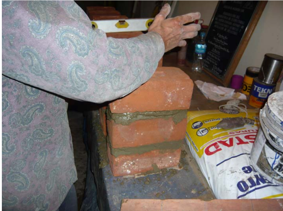
Foto 5.8. Pila de ladrillo “chinchano”.
