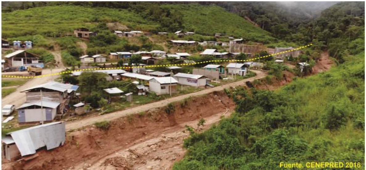
Foto 13. Se limita el sector que pueden ser afectadas por un posible huaico de mayores dimensiones.
