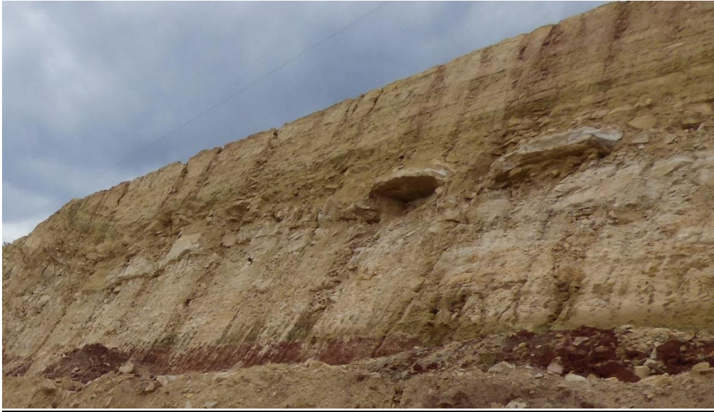
Foto 03: Areniscas blanquecinas de grano fino a medio, laminares, con ligero plegamiento, de la Formación Chonta.
