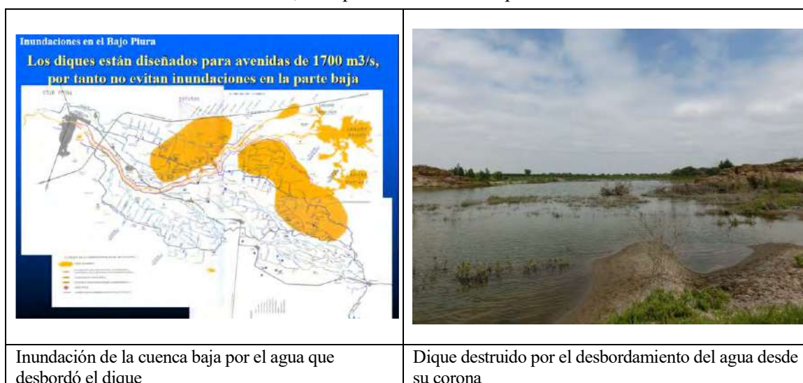
Figura 13.3.34 Daños de inundaciones en la parte baja de la ciudad de Piura
