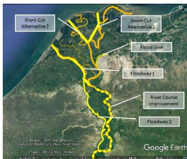
Figura 13.3.31 Esquema conceptual de las medidas básicas que deben ser analizadas en la cuenca del río Tumbes
