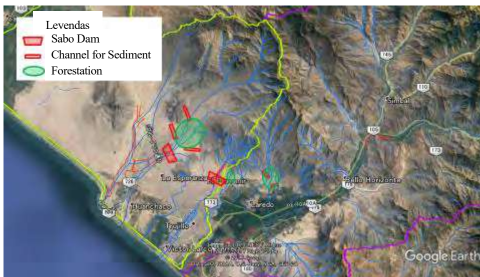
Figura 13.3.74 Disposición de las obras para reducir los daños de huaicos en Trujillo (propuesta)
