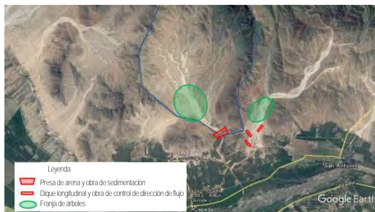
Figura 13.3.80 Disposición de las obras para reducir los daños de deslizamientos en la quebrada Cuculicote, distrito de Ascope (propuesta)
