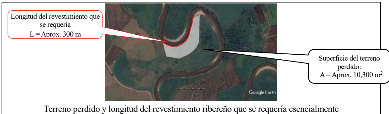
Figura 10.3.2 Situación de erosión en el río Cisa de la cuenca del río Huallaga 2
