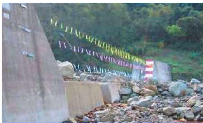
Figura 14.4.14 Caso concreto de instalación del sensor de cables (caso de instalación en un aliviadero)
