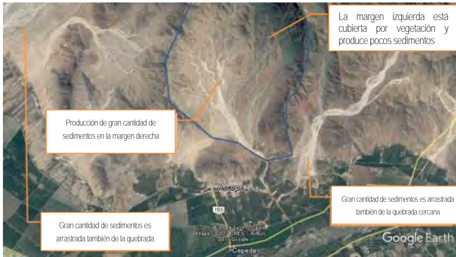
Figura 13.3.76 Características de la producción de sedimentos en la zona de la quebrada. Cuculicote
