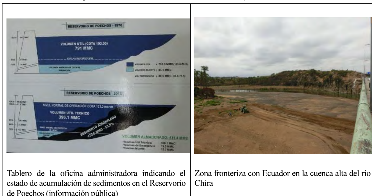
Figura 13.3.51 Condiciones actuales de la acumulación de sedimentos en la presa del Poechos y del arrastre de sedimentos en la cuenca alta
