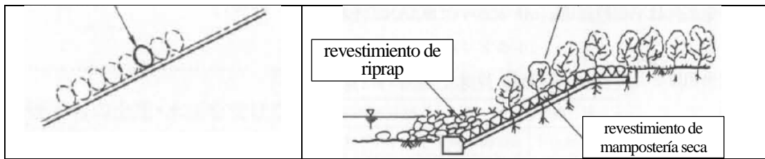
Figura 5.1.14 Típico Corte de Sección Transversal de Revestimiento de Instalación Compuesta (Combinación Fuerte)
