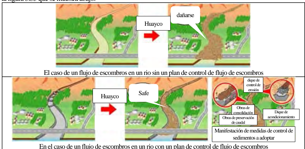
Figura 3.3.5 Efectos de contramedidas estructurales contra flujo de escombros
