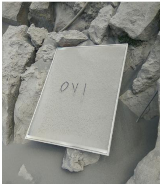
Foto 5: Paneles solares de la estación de monitoreo del Observatorio Vulcanológico del INGEMMET cubierta con ceniza.
