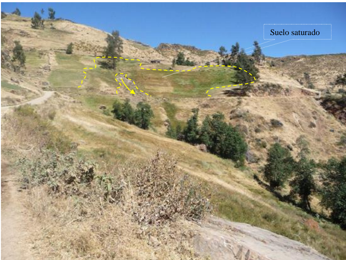
Foto N° 7 Vista panorámica del suelo saturado y deslizamiento menor de longitud de corona de 4.55 m y la distancia de la corona al pie del deslizamiento es de 12.65
