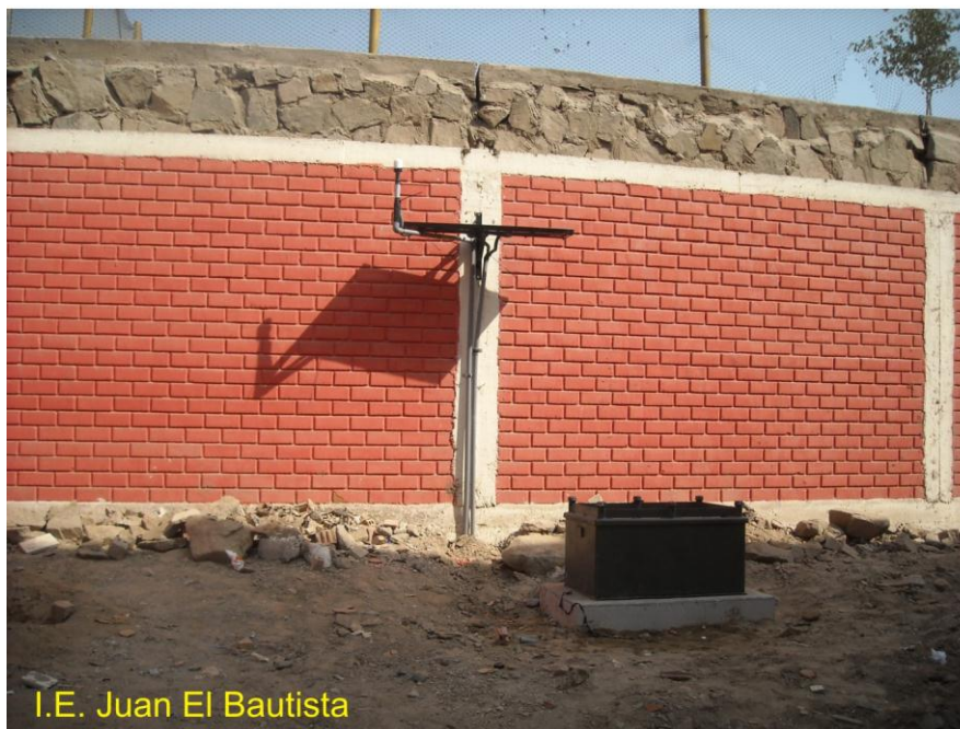
Figura 11a: Estaciones acelerométricas instaladas en los locales del Consejo de la Comunidad Urbana Autogestionaria de Huaycan y en el I. E. Juan El Bautista de Huaycan
