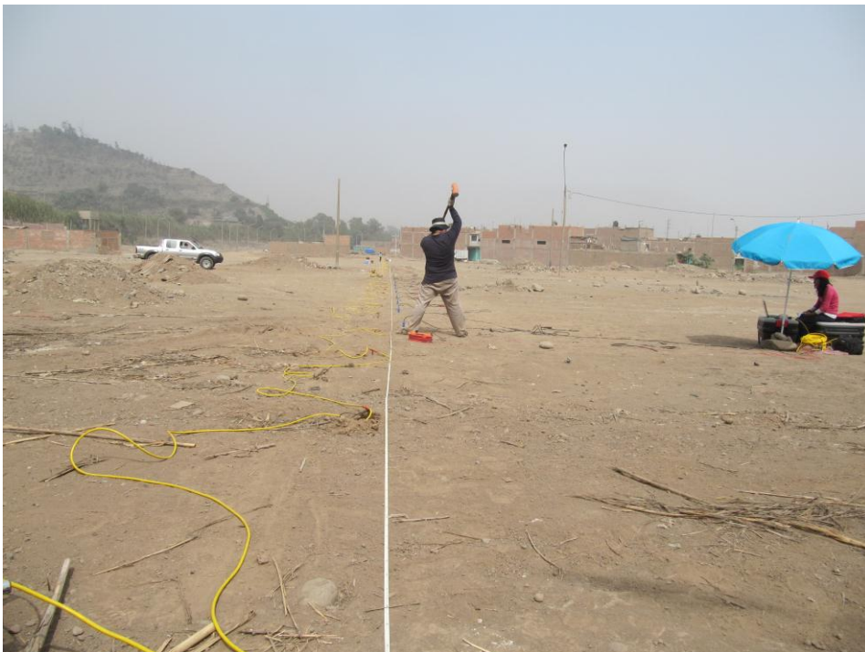
Figura 7: Imagen de la disposición del equipo de refracción sísmica para la toma de data
