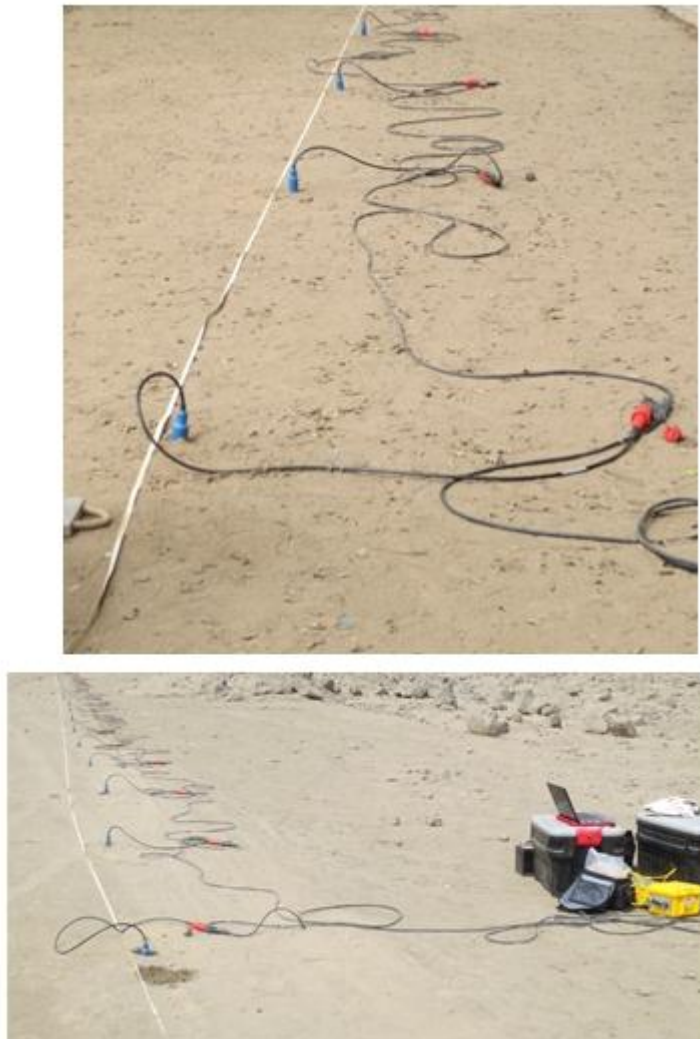
Figura 35: Imágenes de la disposición del equipo de refracción sísmica para la toma de data
