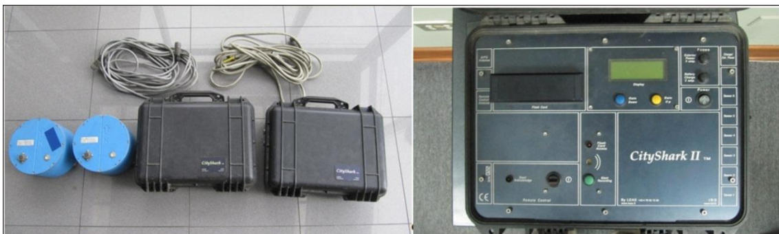
Figura 4: Equipo sísmico utilizado para el registro de vibraciones ambientales: sensores Lennartz (2N) y registrador CityShark
