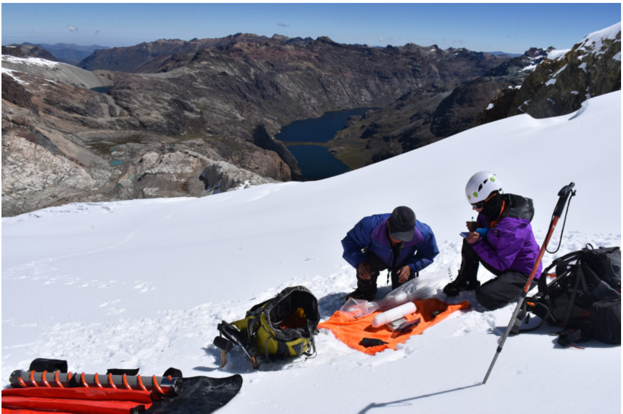
Fotografía 50. Perforación del pozo de densidad en el glaciar Ticlla - Cordillera Central.
