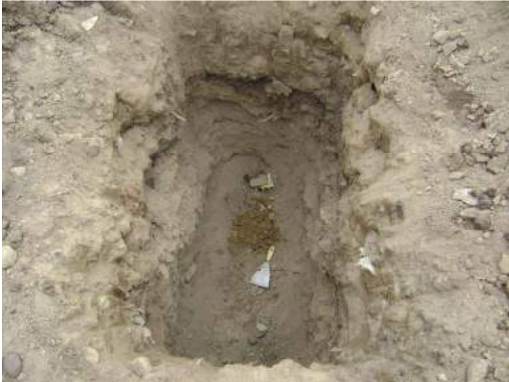
FOTO N° 01: Calicata N° 01, ubicado al lado izquierdo de la carretera Chincha Alta-Alto Larán. Como cobertura se nota la presencia de desmonte y basura, el material del fondo corresponde a un suelo limo arenoso.
