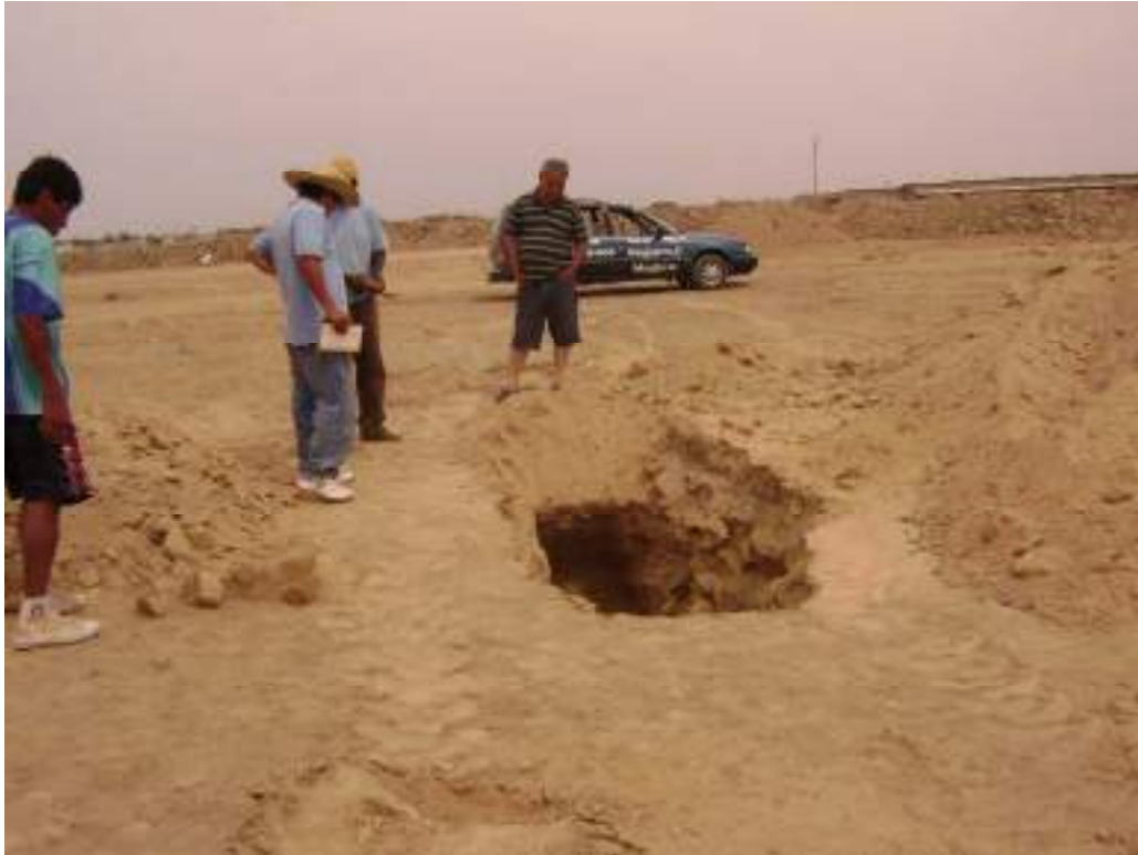
FOTO N° 08: Calicata N°25, ubicado frente a la fábrica textil IPASA en Pueblo Nuevo, el suelo corresponde a un material areno limos que no contiene piedras.
