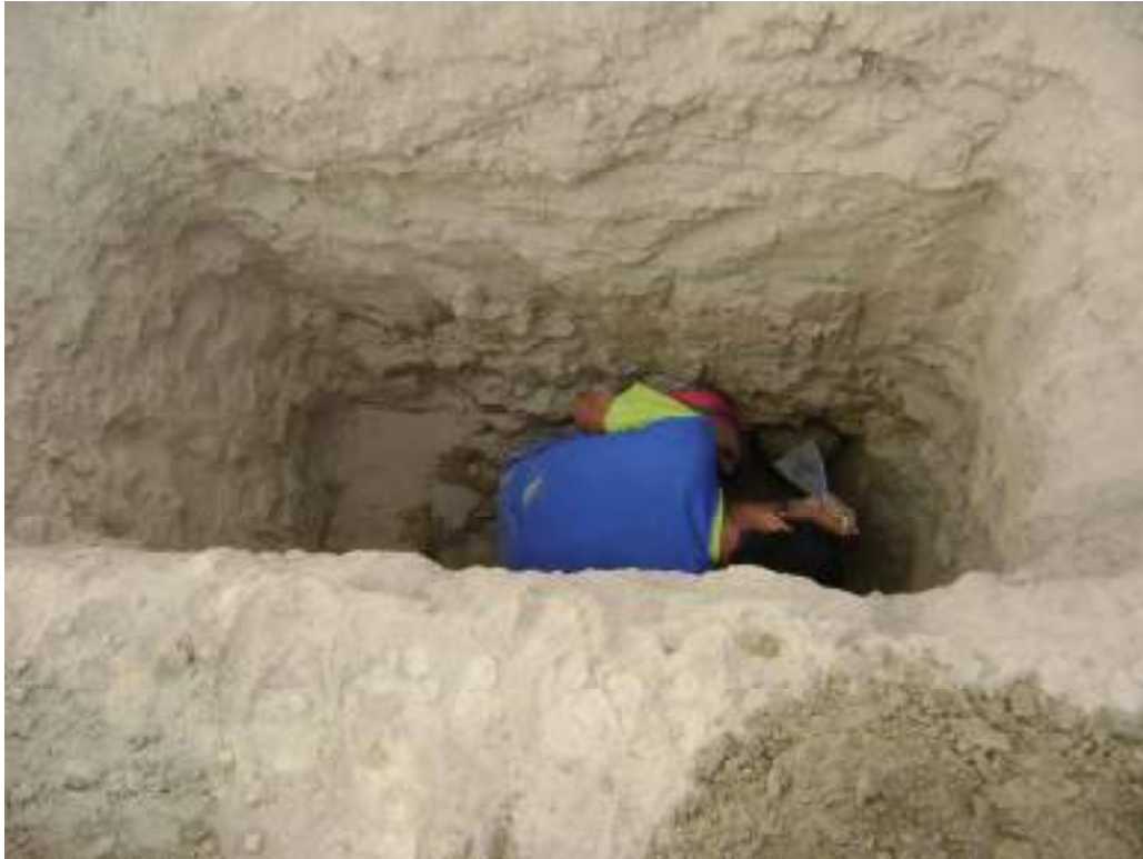
FOTO N° 06: Calicata N°15, ubicado en San Ignacio de Sunampe, el material corresponde a un suelo limo arenoso, en la vista se aprecia la extracción de muestra para el ensayo de corte directo.
