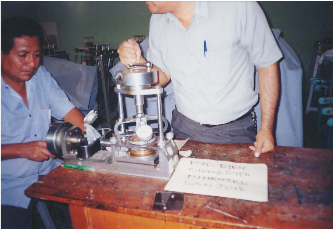
Foto Nro. 6. Preparación del Ensayo de corte directo
