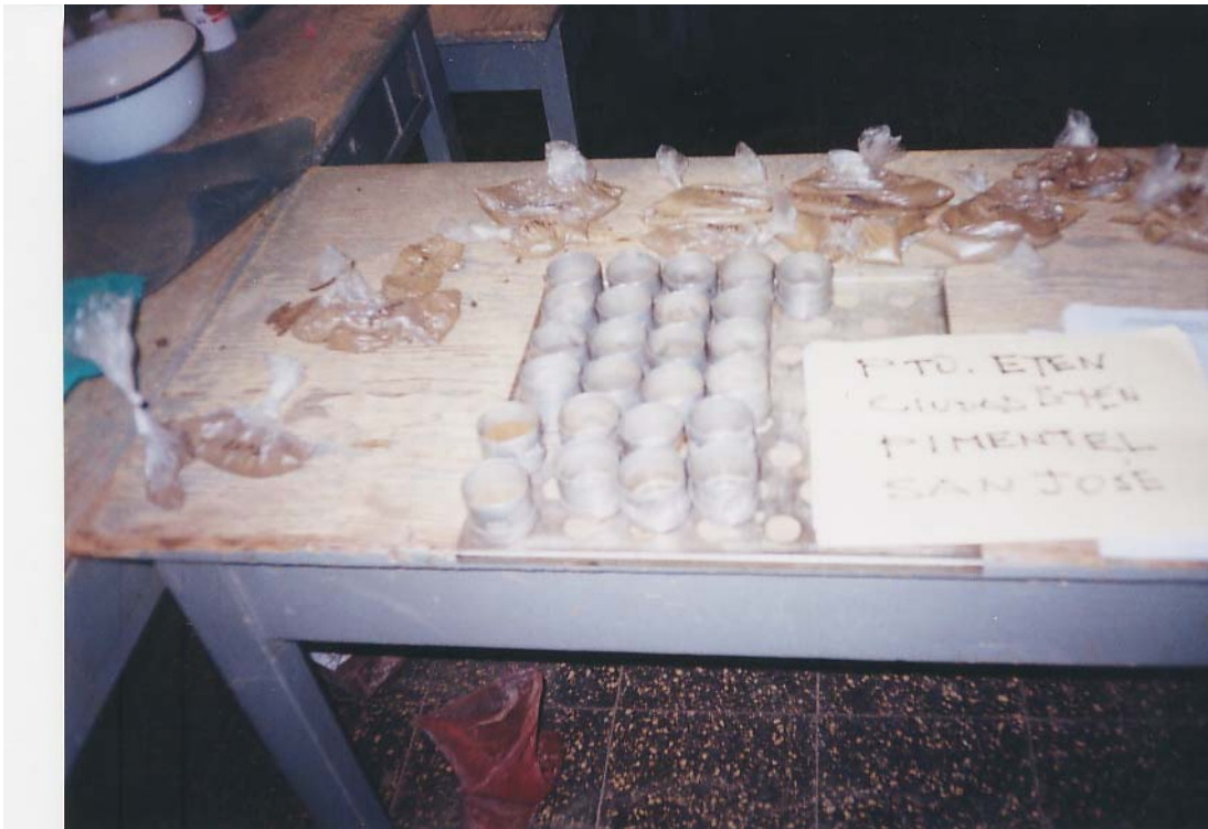
Ensayo de contenido de humedad
