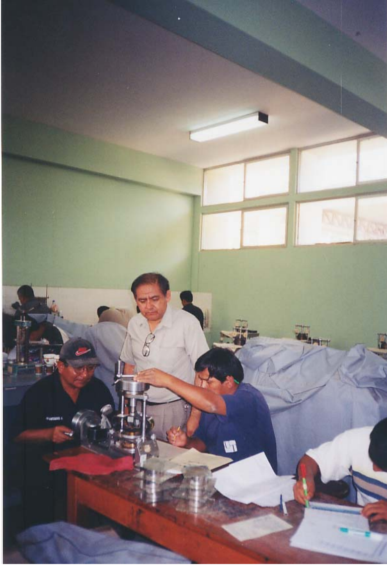
Supervisión del ensayo de corte directo.
