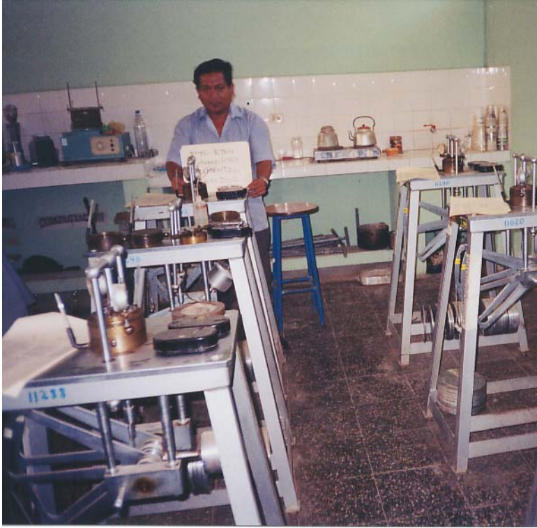
Varios equipos para el ensayo de consolidación
