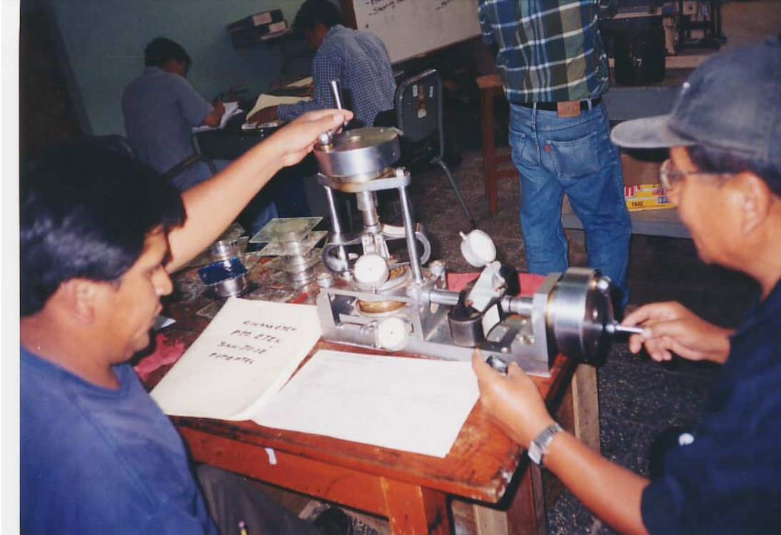
Ensayo de corte directo
