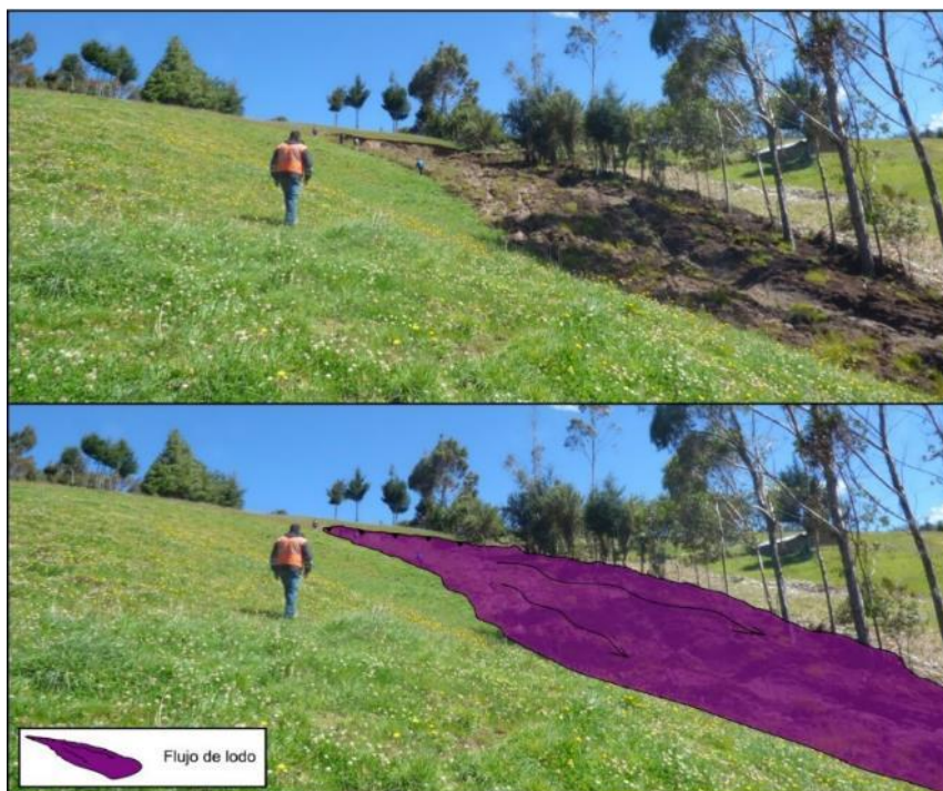
Figura 16: Alcance del flujo de tierra ladera abajo, en el terreno del Sr. Alberto Herrera (foto inferior interpretada).
