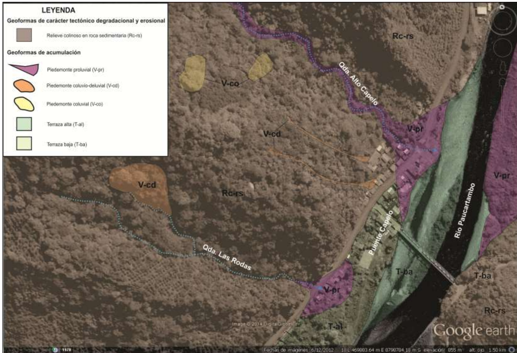
Figura 2. Imagen Google Earth donde se ha delimitado las diferentes unidades geomorfológicas que se presentan en el sector de Puente Capelo.
