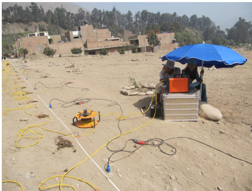
Figura 9: Imagen de disposición del equipo de prospección eléctrica para la toma de datos
