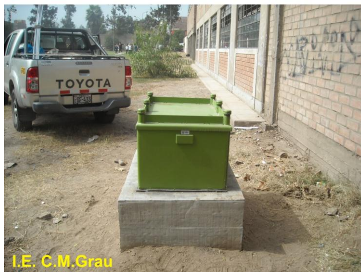
Figura 11a: Estaciones acelerométricas instaladas en los locales de INDECI y el I. E. Almirante Miguel Grau de Chaclacayo
