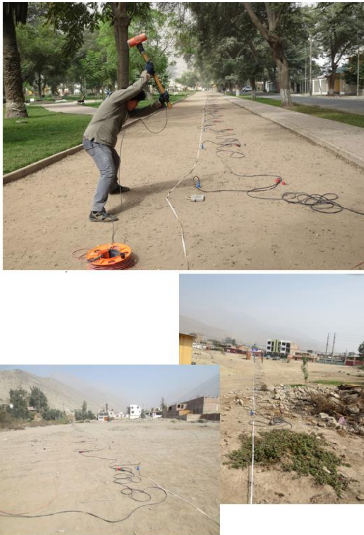
Figura 45: Imágenes de la disposición del equipo de refracción sísmica para la toma de data
