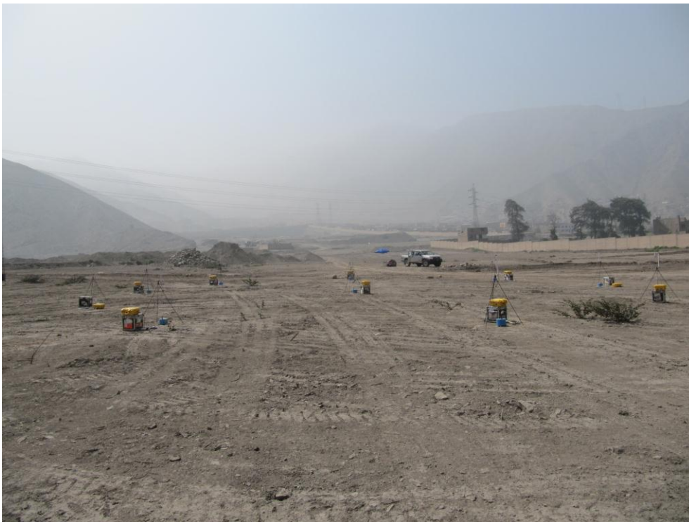
Figura 8: Imagen de arreglos sísmicos circulares para la toma de datos
