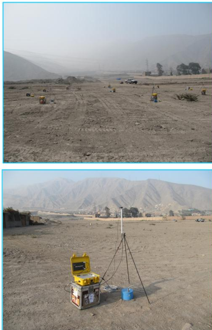
Figura 54: Imágenes de los arreglos sísmicos circulares realizados en Chaclacayo. Se muestra la distribución y disposición del equipo sísmico a diferentes distancias radiales.
