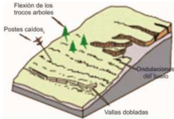
Figura 10. Esquema de reptación de suelos. (Cruden y Varnes, 1996)
