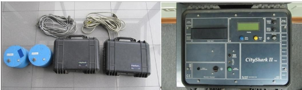
Figura 39: Equipo sísmico utilizado para el registro de vibración ambiental: sensores Lennartz (2N) y registrador CityShark
