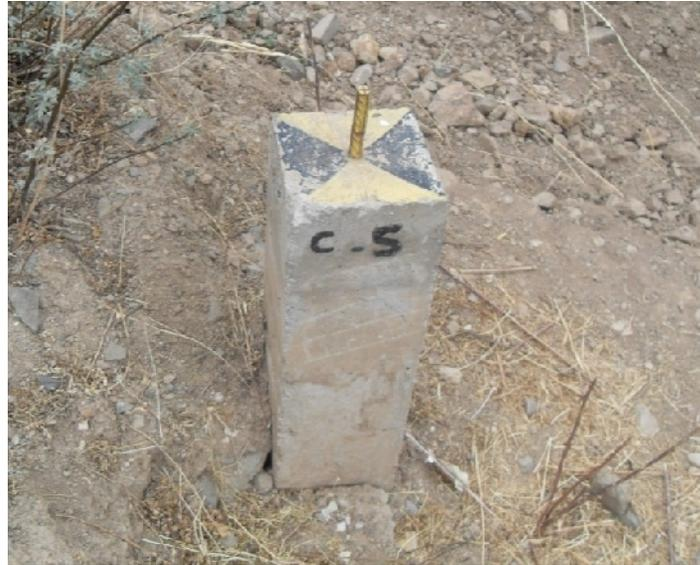
Figura 31.- Hito de monitoreo con extensómetro de cinta
