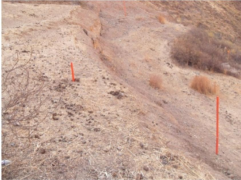
Figura 11: Depósitos coluviales en la parte de la ladera, sector cobertizos (Figura 9)
