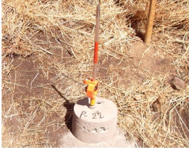
Figura 26: Hito de control topográfico reconstruido en la zona de cobertizos.
